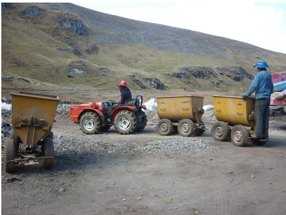
**LOCOMOTORA – Mina Yuringa. Que tracciona hasta 5 carritos mineros de 1 TM de Capacidad.**
