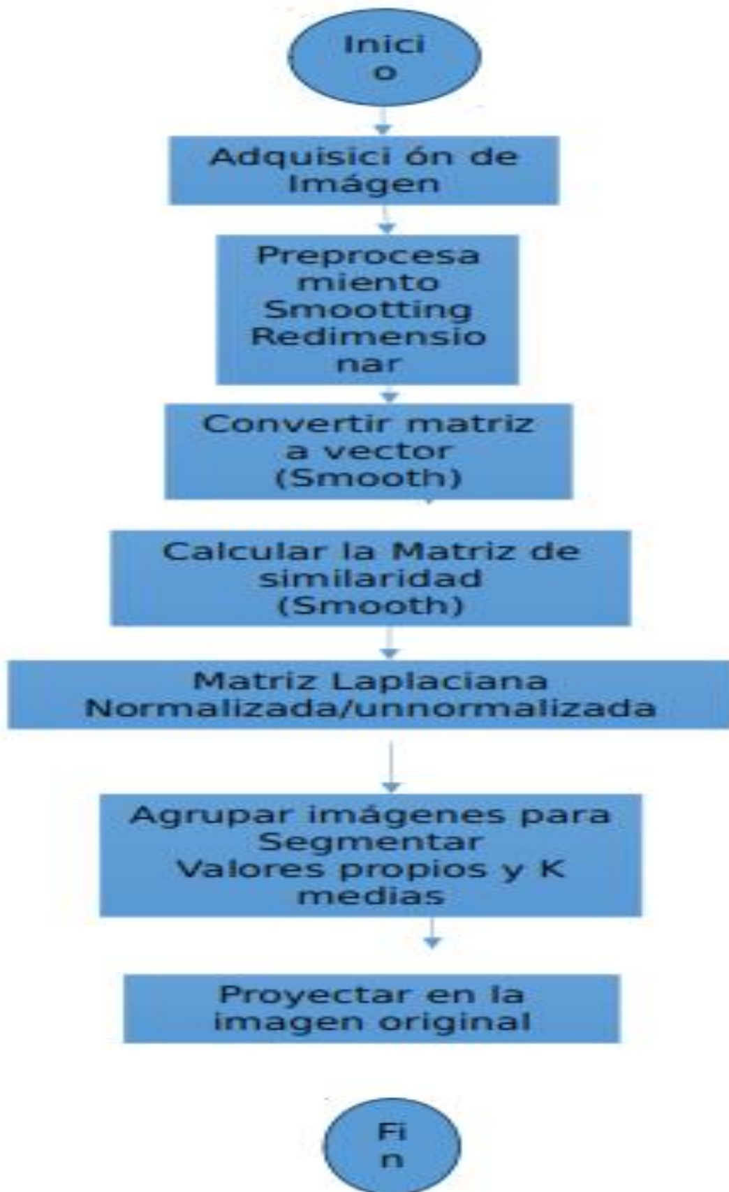
Figura 9. Diagrama del software para la segmentación de imágenes
