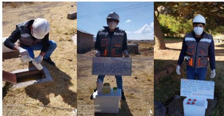
Nota: observamos el muestreo del afluente al biodigestor.
