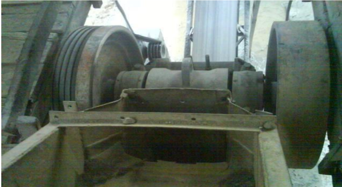
Chancadora de quijadas (9" x 12") del circuito de Chancado de Planta San Carlos.
