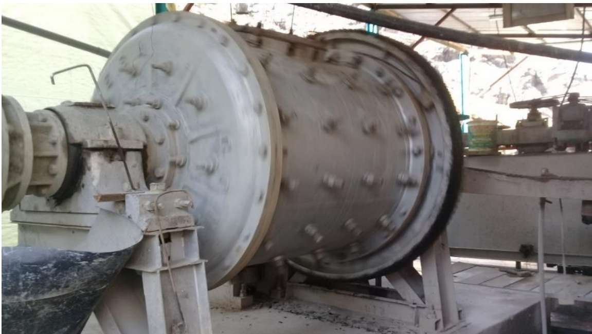
Molino COMESA 4' * 4' Circuito de Molienda de la Planta San Carlos.
