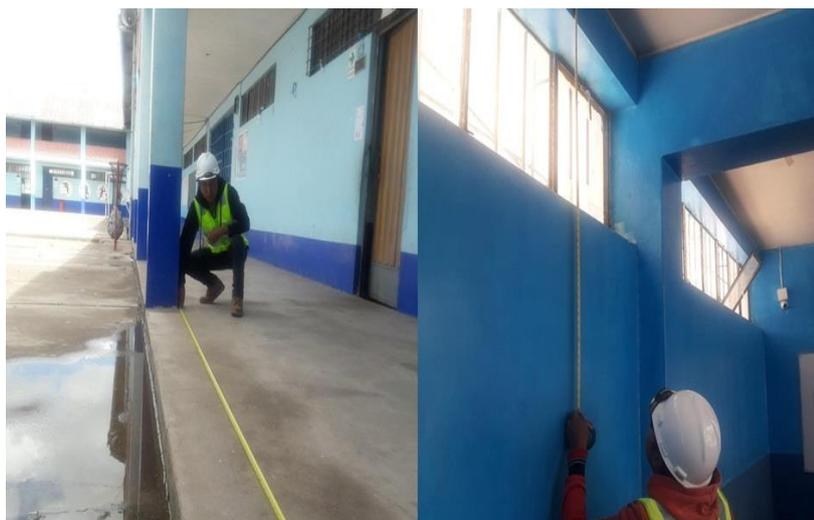
*Nota:* Medición de los elementos estructurales, no estructurales, columnas cortas, dimensión entre ejes, cuyo resultado final serán los planos de la edificación, en la imagen se muestra la recolección del pabellón 01.
