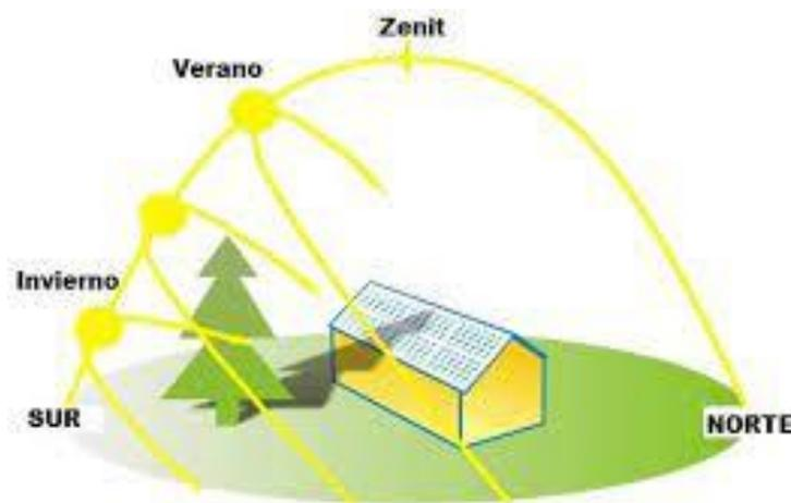
Figura 9. Orientación, inclinación y sombras en fotovoltaica
