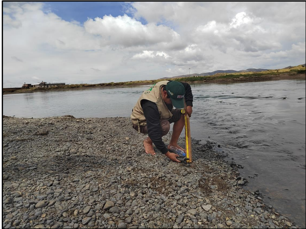
Nota. Medición de la profundidad del agua del río Coata
