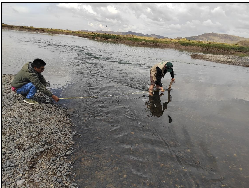
Nota. Medición de la longitud de la sección del río Coata
