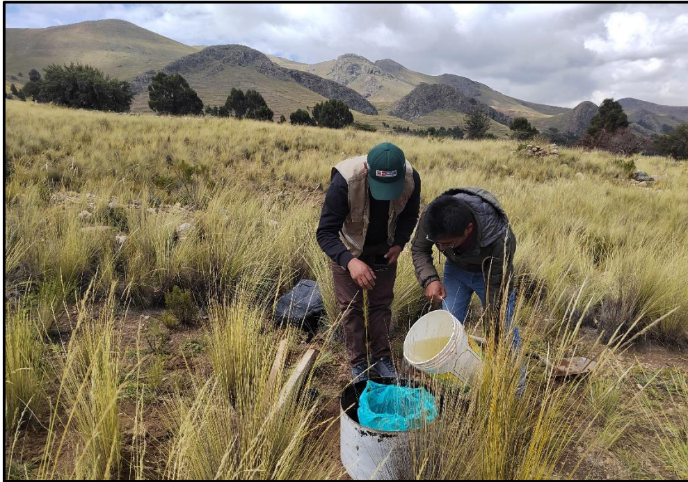
Nota. Prueba de infiltración por el método de doble anilla
