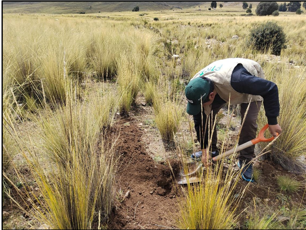
Nota. Preparación del terreno para la prueba de infiltración
