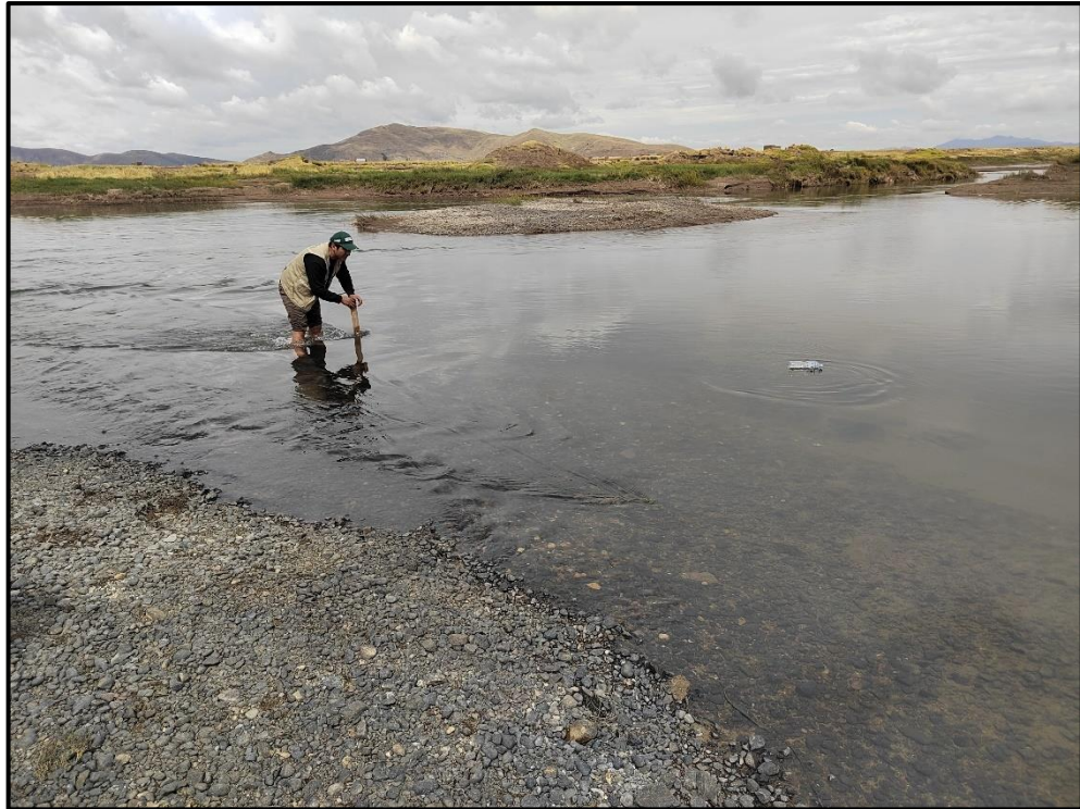
Nota. Medición del caudal de la cuenca del río Coata
