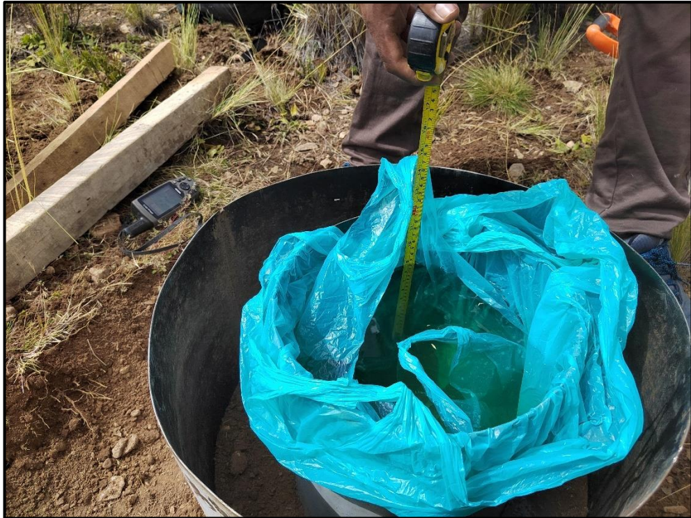
Nota. Prueba de infiltración por el método de doble anilla
