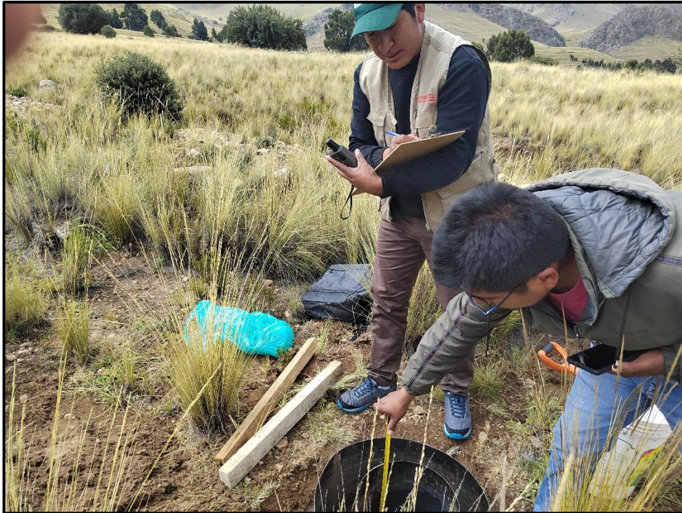
Nota. Toma de datos de la prueba de infiltración por el método de doble anilla
