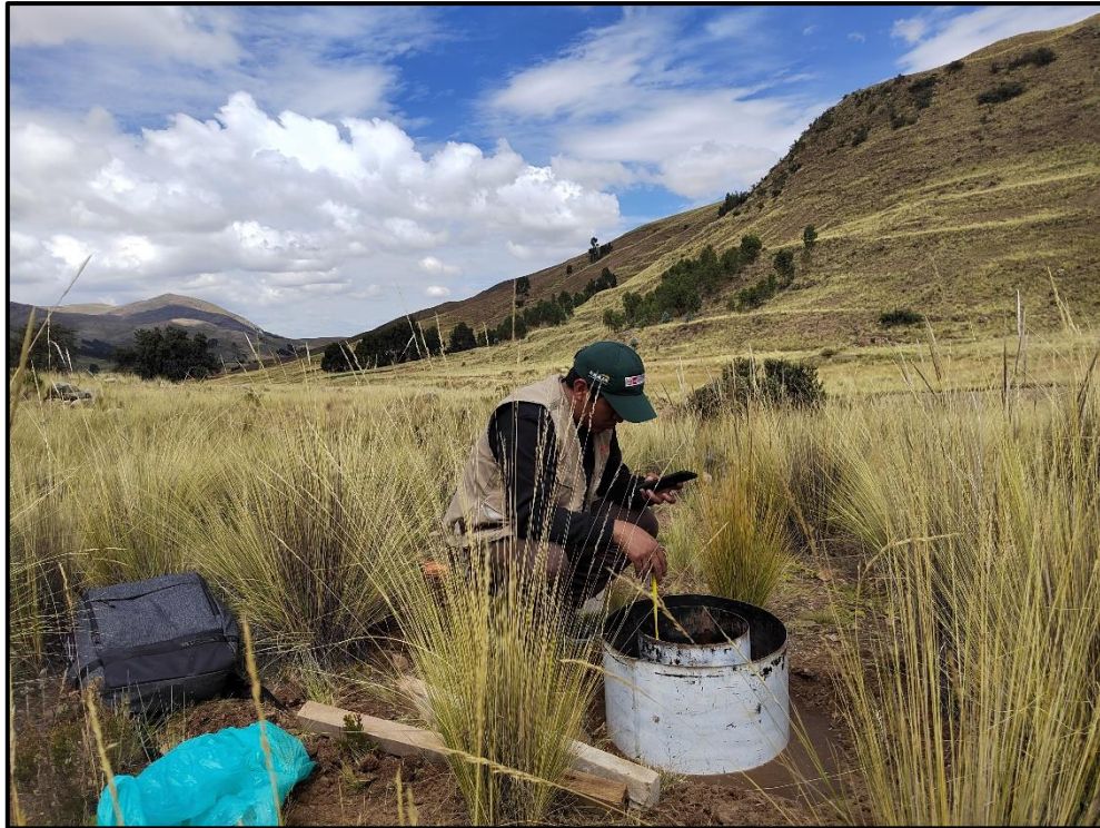
Nota. Medición de la altura y tiempo de infiltración por el método de doble anilla
