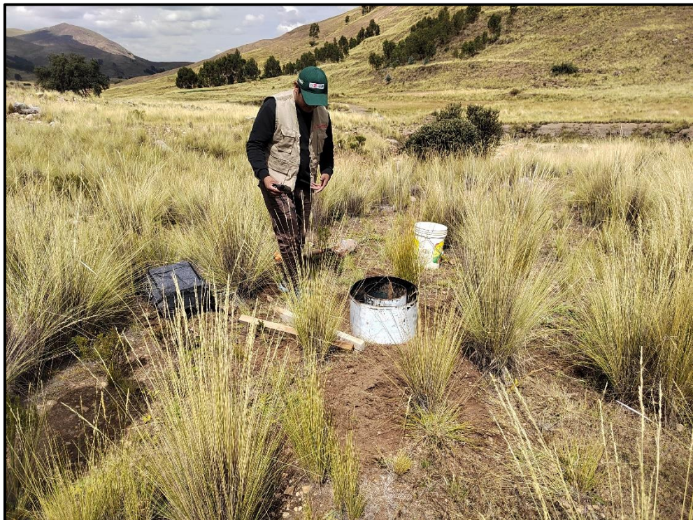
Nota. Disposición de materiales para la prueba de infiltración por el método de doble anilla
