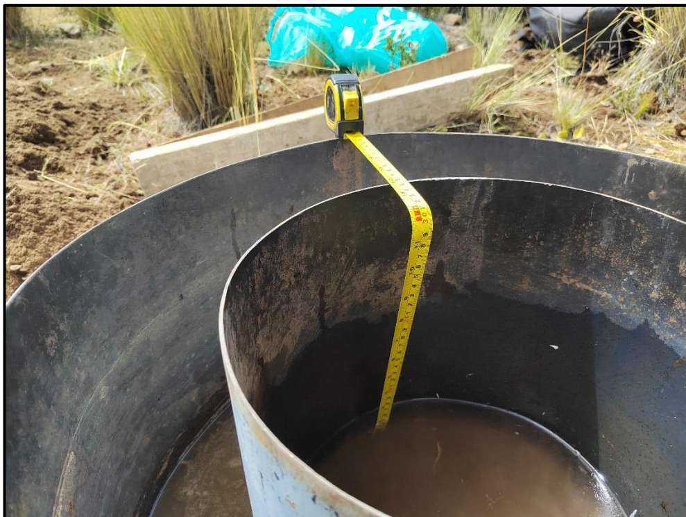
Nota. Altura de infiltración por el método de doble anilla
