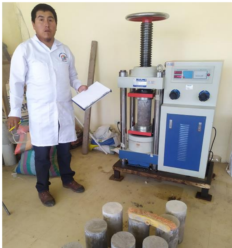
Foto 04. Rotura de briquetas de concreto
