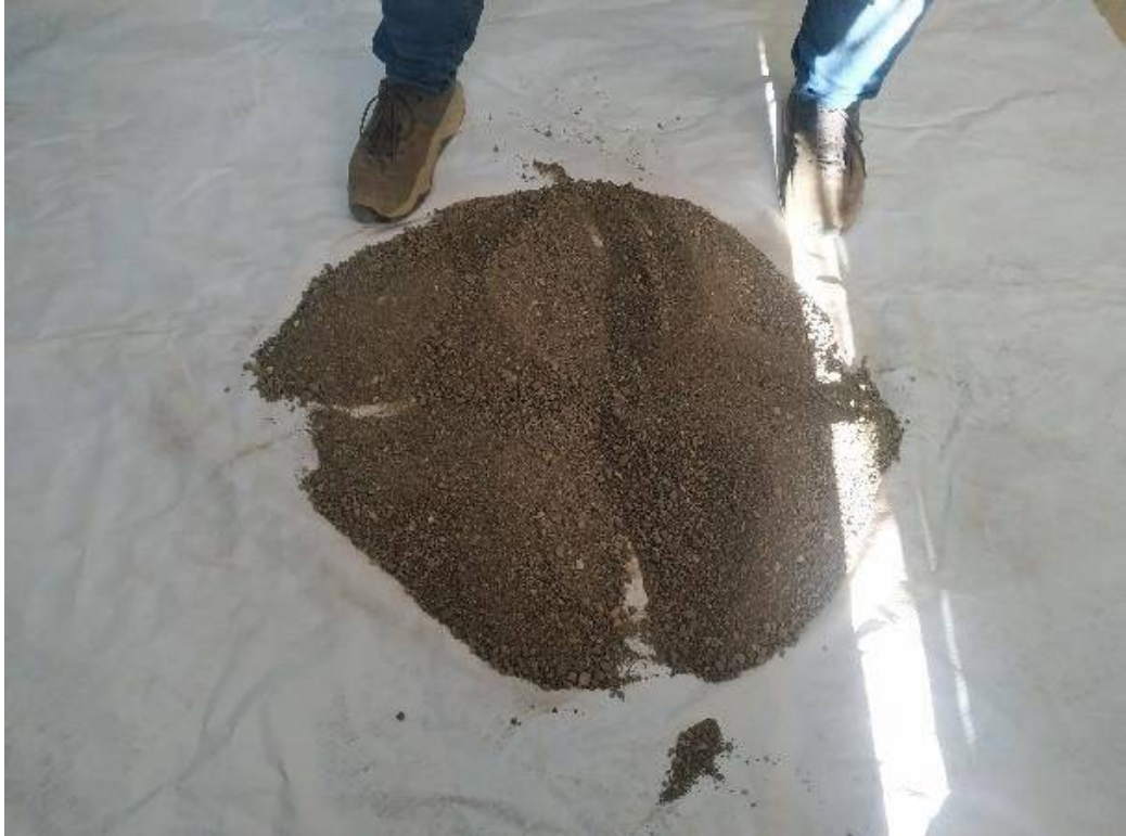
Ilustración 5. Cuarteo de agregado fino ASTM C29 / C29M – 17 a
