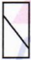
Tipo 4 Fractura diagonal sin fisuras a través de los extremos, golpee suavemente con un martillo para distinguirla del tipo 1.
