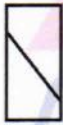
Tipo 4 Fractura diagonal sin fisuras a través de los extremos, golpeada suavemente con un martillo para distinguirla del tipo 1.
