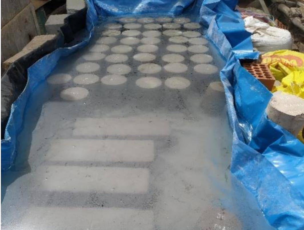
Ilustración 13. Curado de muestras cilíndricas y prismática
