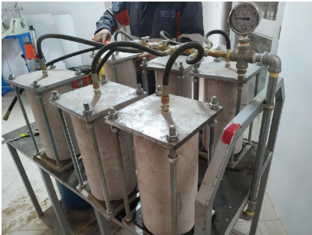
Ilustración 18. Dispositivo para ensayo de profundidad de penetración de agua norma UNE-12390-8.
