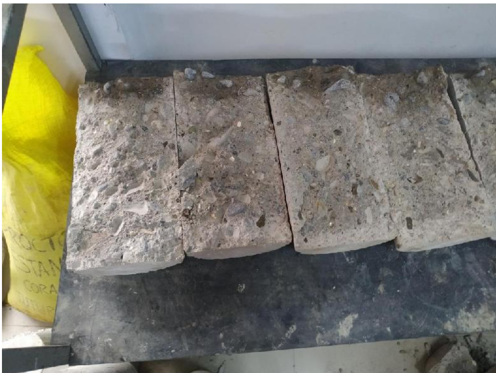
Ilustración 24. Se muestra la profundidad de penetración de agua bajo presión.
