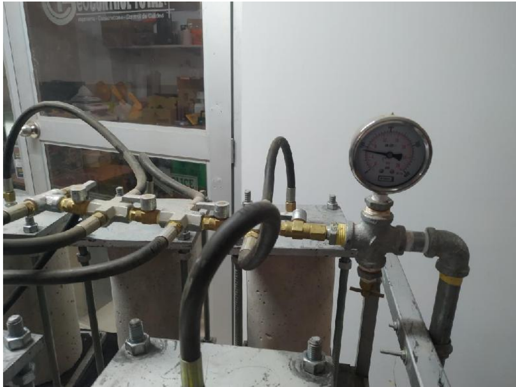
Ilustración 19. Manómetro de deformación elástica para mantener la presión 500 \pm 50 Kpa de acuerdo a la norma UNE-12390-8.
