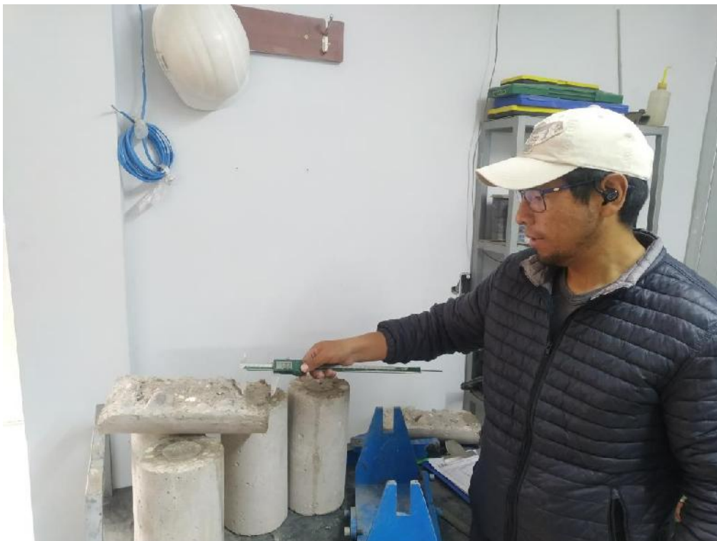
Ilustración 22. Medición de la profundidad de penetración máxima de agua bajo presión
