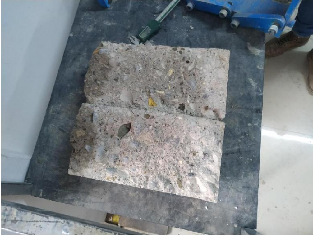
Ilustración 23. Se muestra la profundidad de penetración de agua bajo presión.
