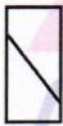
Tipo 4 Fractura diagonal sin fisuras a través de los extremos, golpee suavemente con un martillo para distinguirla del tipo 1.
