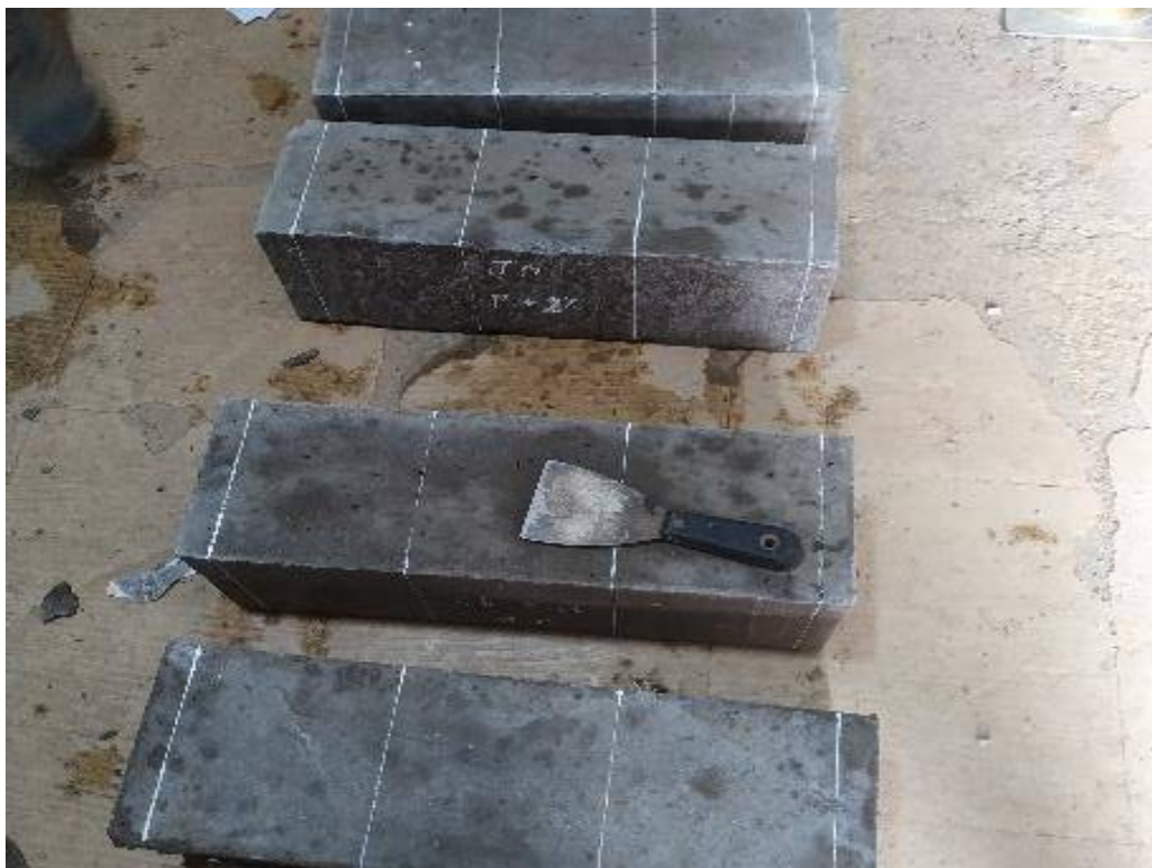
Ilustración 16. Marcado de punto de apoyo donde se aplicarán las cargas en flexión de vigas
