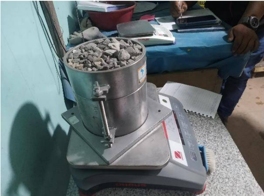
Ilustración 6. Peso unitario suelto de Agregado grueso ASTM C29 / C29M – 17 a
