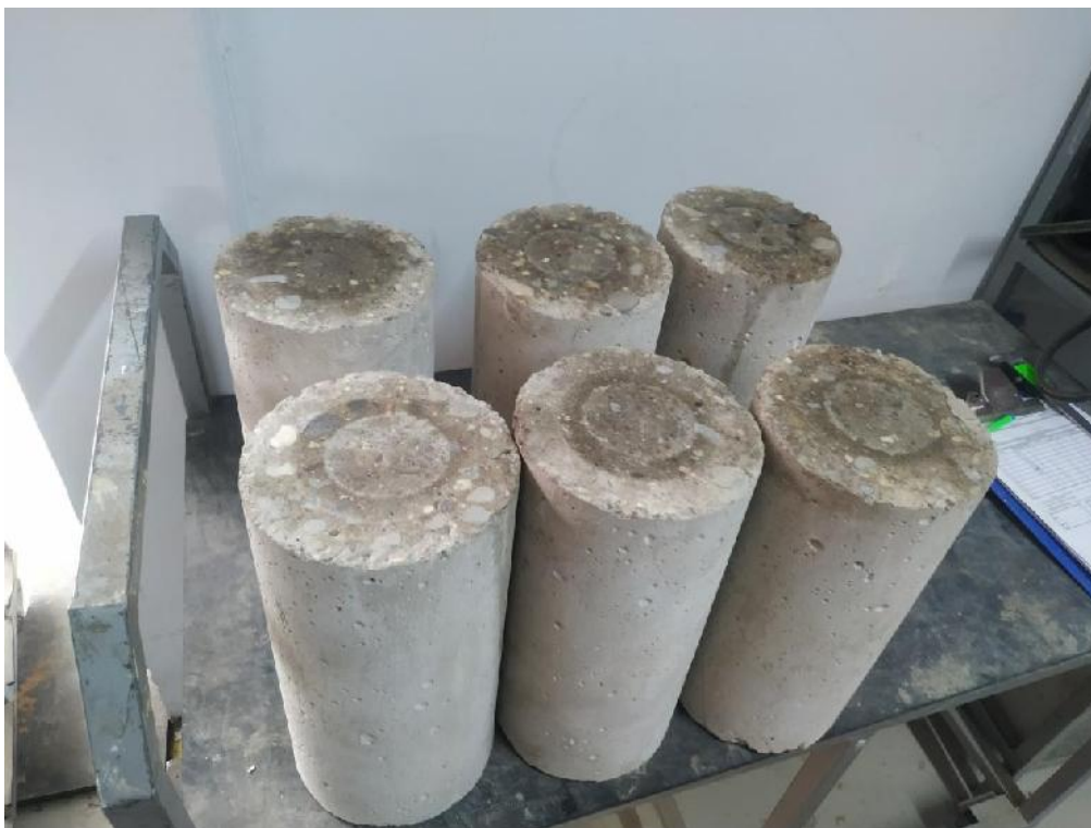
Ilustración 20. Muestras después de ser sometidas a presión 500 \pm 50 Kpa durante 72 \pm 2 horas de acuerdo a la norma UNE-12390-8.
