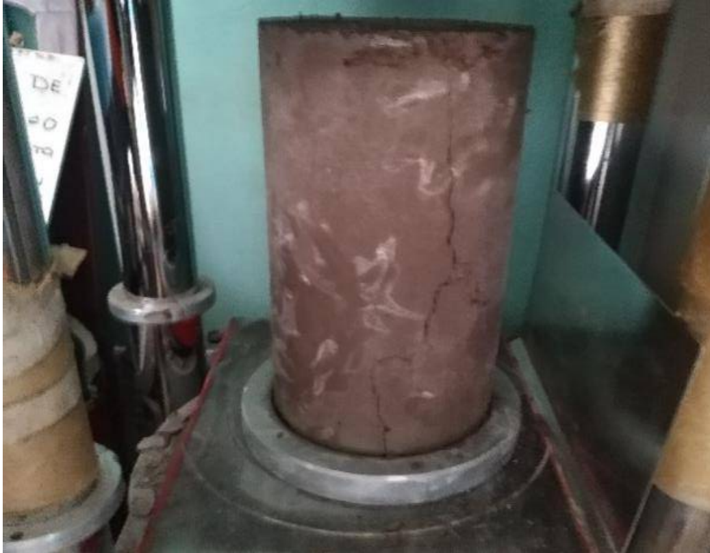
Ilustración 15. Verificación de tipo de rotura de acuerdo a la norma ASTM C39.
