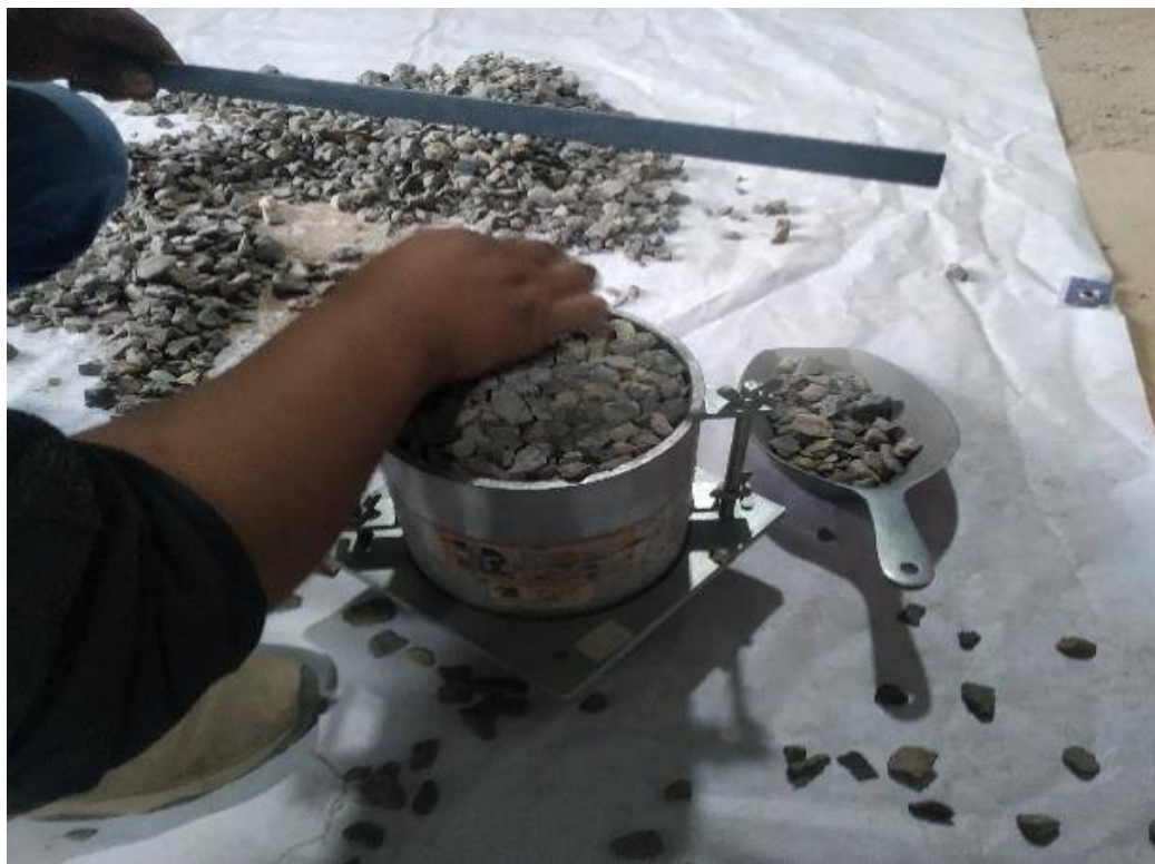
Ilustración 8. Cuarteo de agregado grueso ASTM C29 / C29M – 17a
