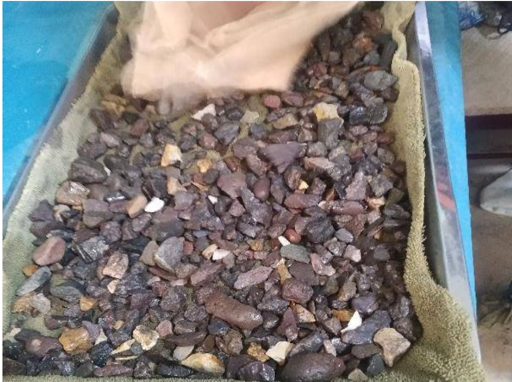
Ilustración 7. Prueba de absorcion de Agregados gruesos ASMT C127-15
