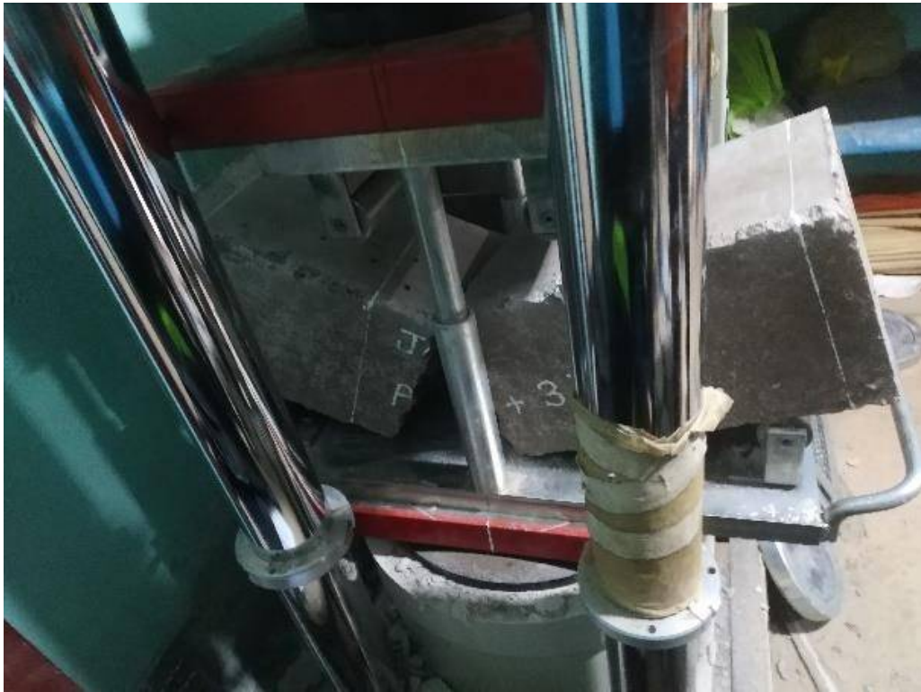
Ilustración 17. Verificación de rotura en tercio central de viga prismática
