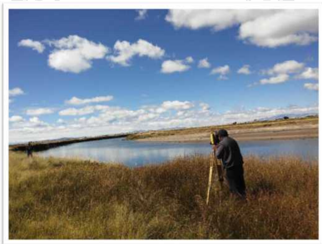
FIGURA 2-2 LEVANTAMIENTO CON LA STCION TOTAL EN EL MARGEN IZQUIERDO DEL RIO (ELABORACIÓN PROPIA)
