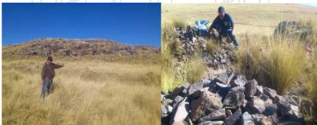
FIGURA 2-10 SE MUESTRA LA CANTERA DE ROCAS CHUTANCOLLO QUE TIENE UN POTENCIAL DE 50,000 M 3 APROXIMADAMENTE, TOMANDO MUESTRAS PARA SUS RESPECTIVO ENSAYO)
