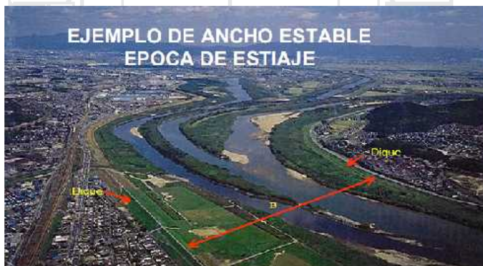
FIGURA 3-28 ANCHO ESTABLE DEL RIO
