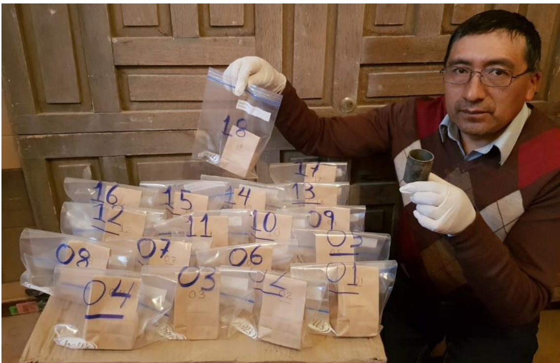
Muestras de suelos destinados a laboratorio, para el análisis de densidad aparente
