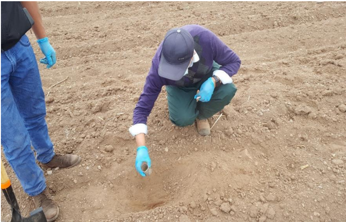
Limpeza de área para la toma de muestra para densidad aparente
