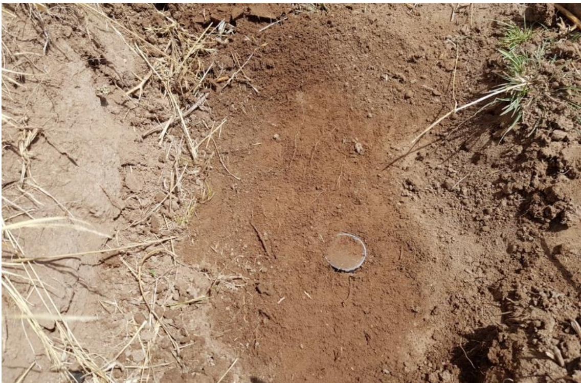
Toma de muestra de suelo para densidad aparente a través del método del cilindro
