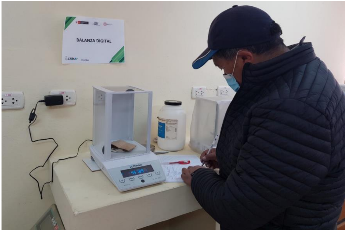
Registro de peso del sobre con balanza de precisión, para análisis de densidad aparente
