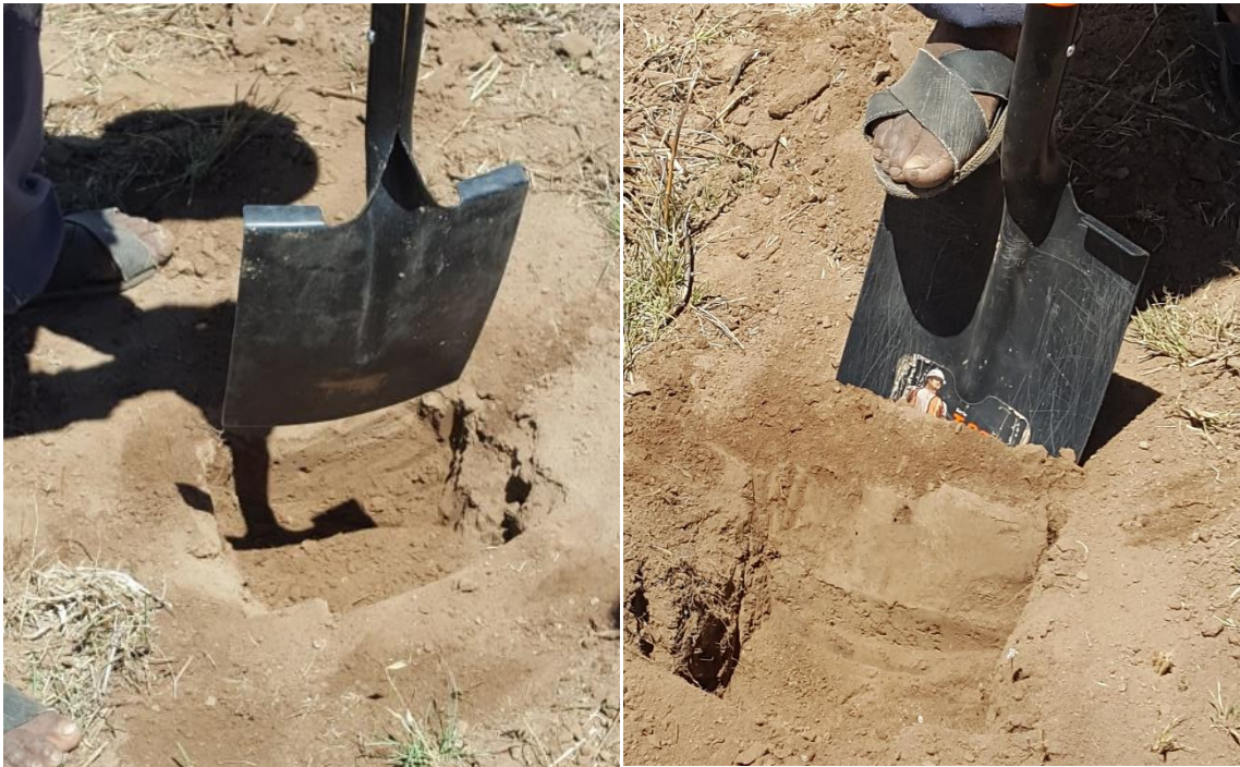
Apertura de hoyo y extracción de sub muestra de suelo
