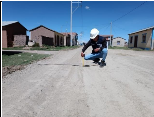
Foto 11: Km 0+500.00 - km 1+000.00, Se observa la medición de la profundidad del deterioro (baches) en la superficie de rodadura "afirmado".
