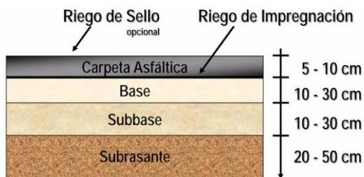
Nota: El gráfico muestra el corte transversal de capas de pavimento flexible. Tomado de: Pavimentos (p.03), por C. Giordani, D. Leone, 2020, Catedra: Ingeniería civil I.
