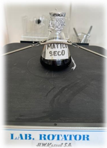
Colocación del extracto de Matico en matraz de Erlenmeyer para su maceración.
