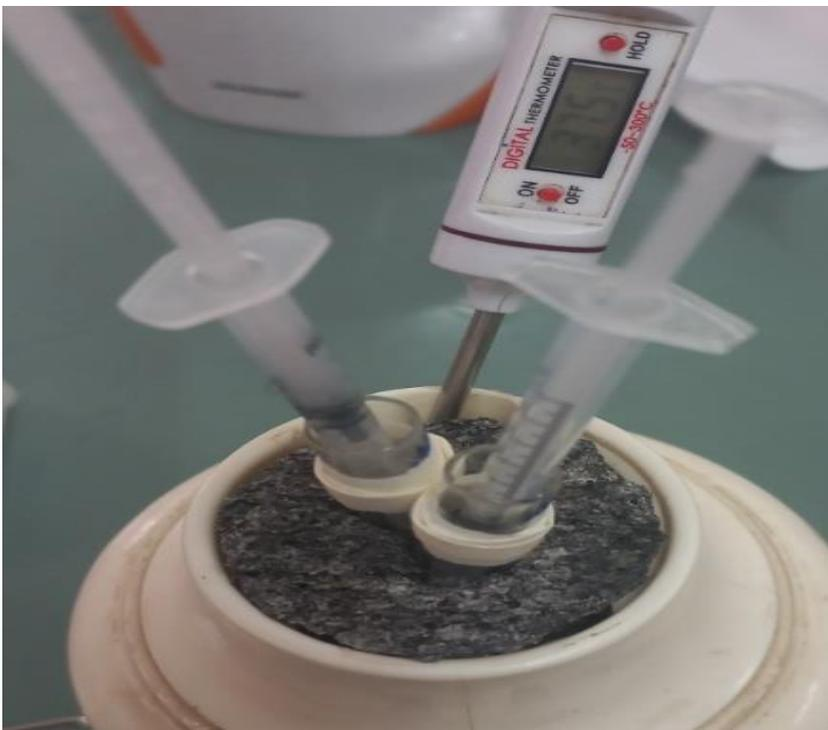
Baño de maría a 37°C, acondicionado en un termo donde se colocaron tubos de ensayo con dilutor y jeringas de colección
