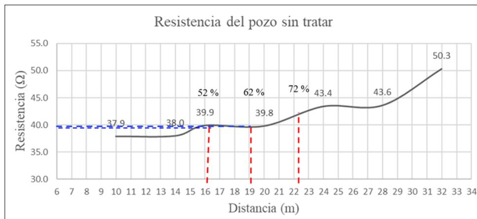
*Nota.* La resistencia del pozo sin tratamiento es de 40 Ohmios, de acuerdo al método de la caída de potencial. Se puede apreciar que es muy similar a la resistencia teórica de 37 Ohmios.
