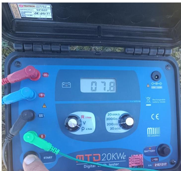
*Nota.* Equipo de medición telurómetro Megabras MTD-20KWe de cuatro polos utilizado para medir la resistividad del terreno.
