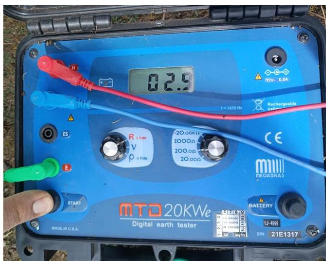
Nota. Equipo de medición telurómetro Megabras MTD-20KWe utilizado para medir la resistencia del pozo a tierra.
