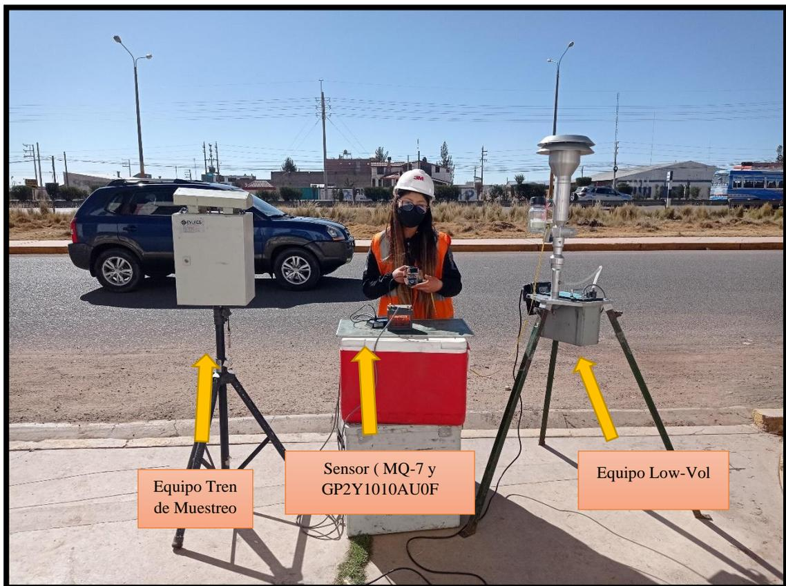
Figura 62. Equipos de medición instalados (Tren de muestreo, Sensores de medición y el Low-vol)
