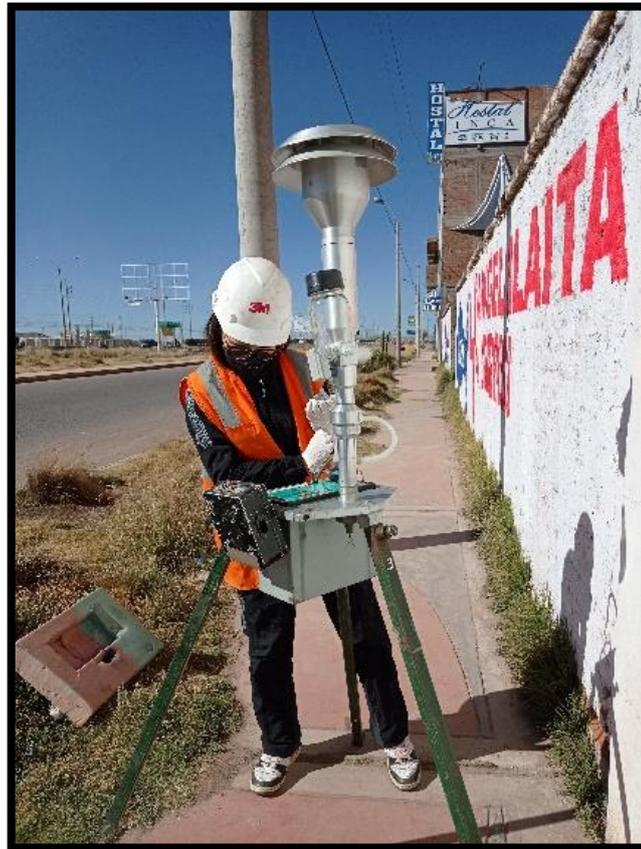
*Figura 59. Ajuste del equipo de medición Lowvol*
