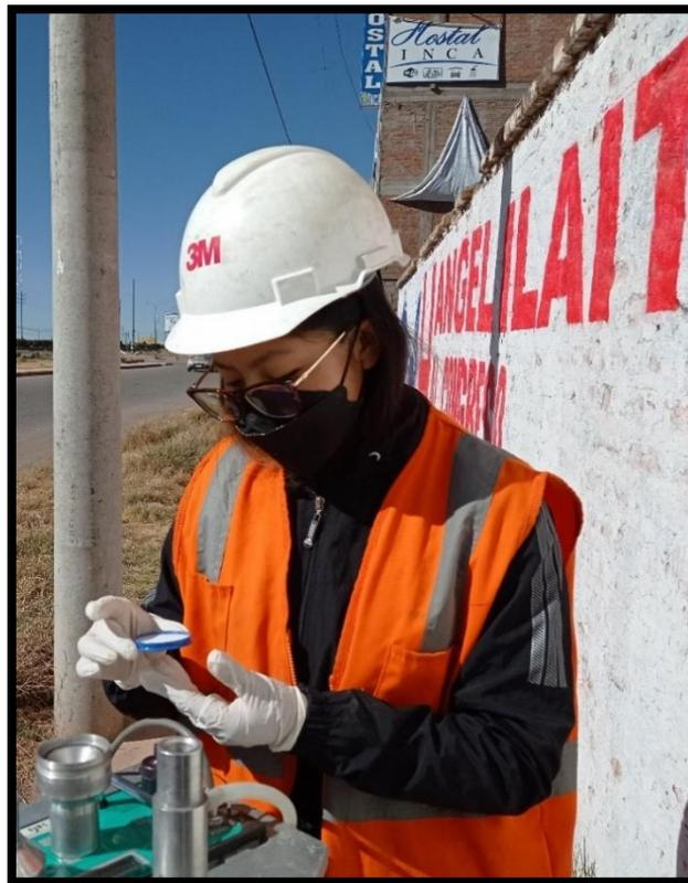
Figura 57. Manejo del filtro pre - muestreo
