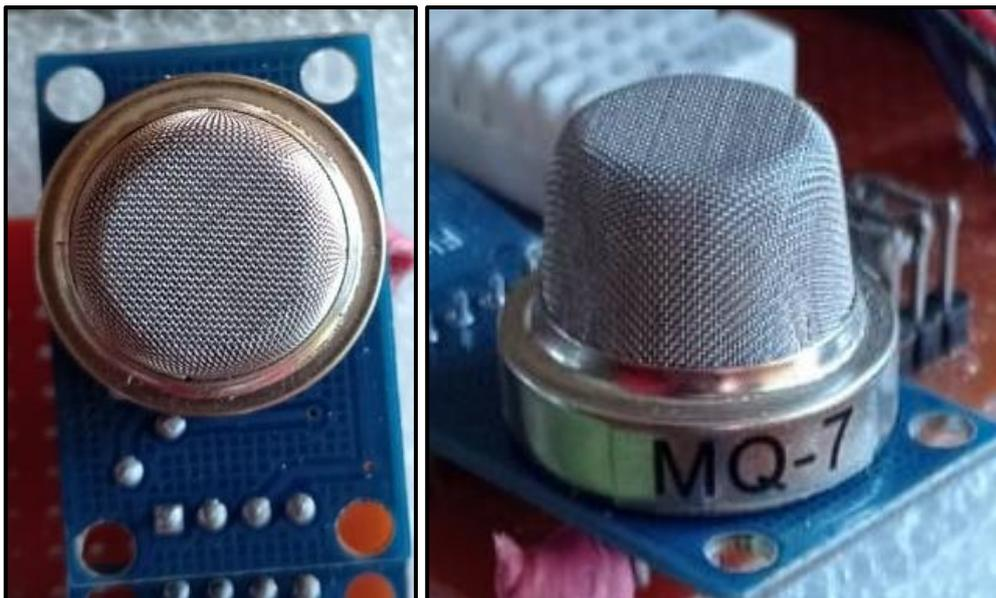
Figura 12. Sensor MQ-7 de medición de CO
