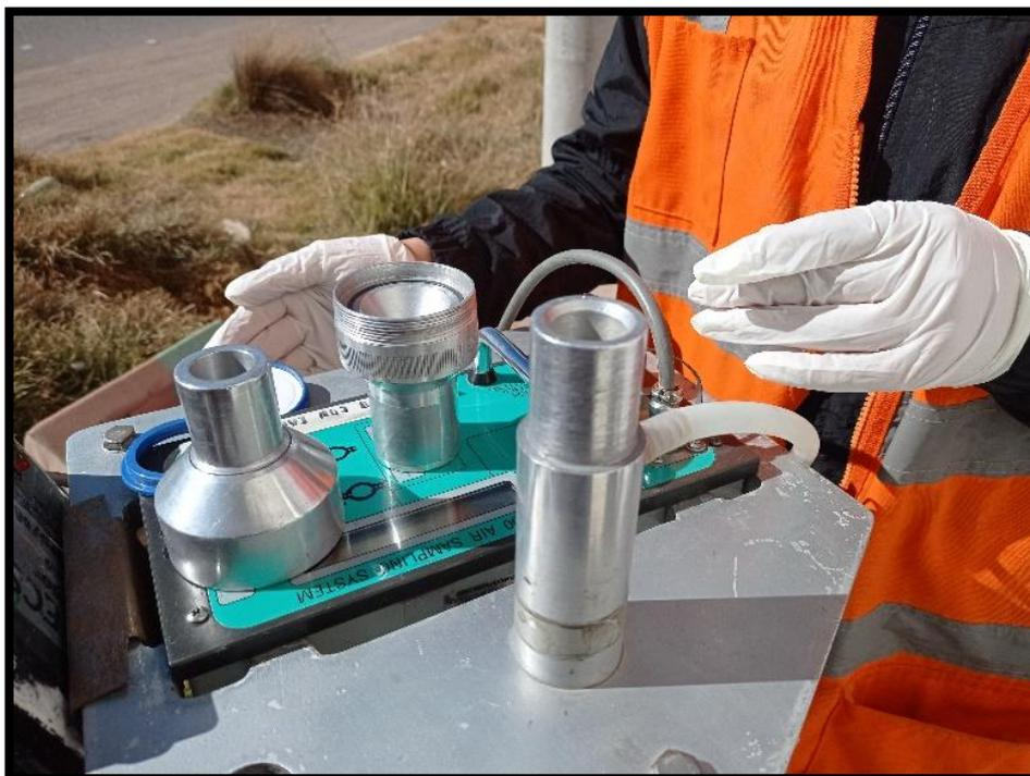
Figura 58. Armado del Muestreador de calidad Low-vol
