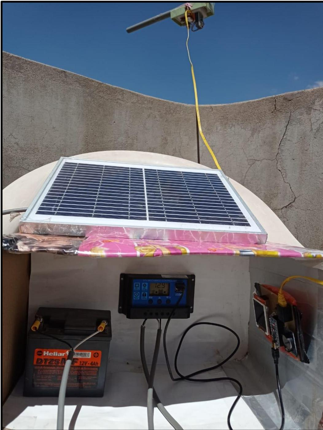
Figura 66. Sistema de red de medición (sensor óptico y electroquímico)
