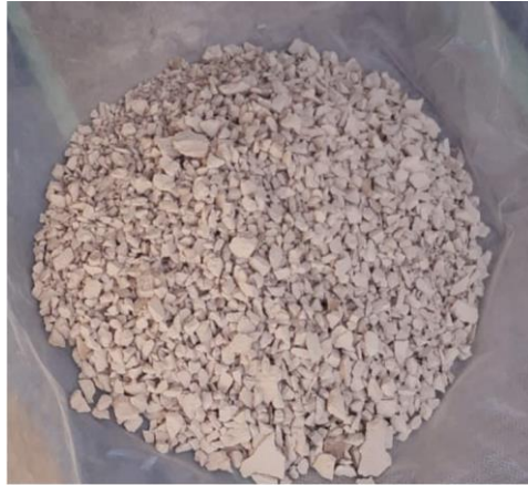
Figura 18. Resultado de la chancadora de mandíbula (Fuente: Propia)
