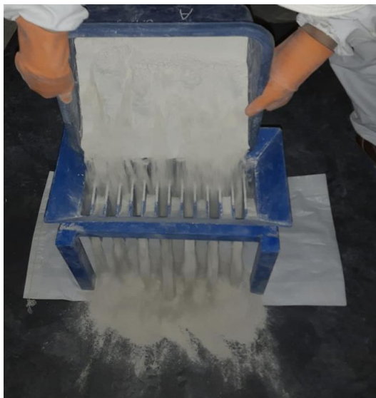
Figura 20. Cuarteado por rifleado (Fuente: Propia)
