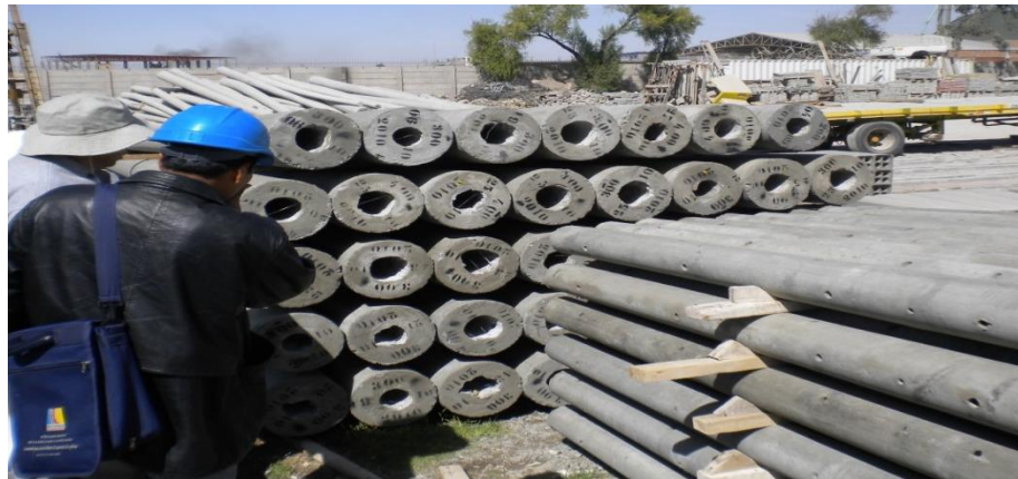
Figura 4: Poste de Concreto Armado Centrifugado
