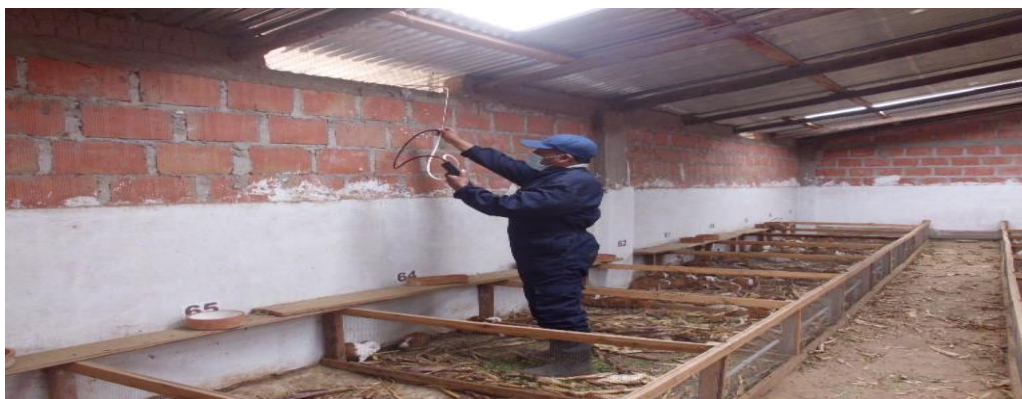
Figura 7. Registro de velocidad del viento en un punto de ventilación del galpón
