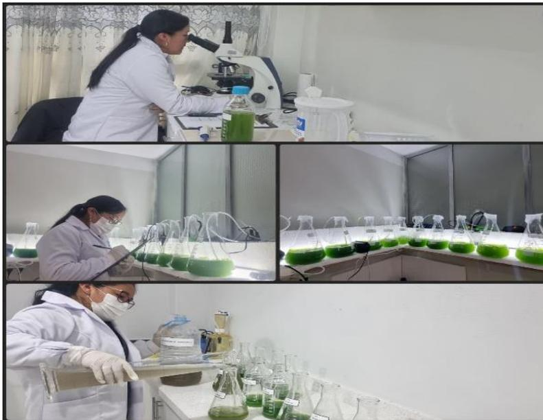
Figura 7. Adecuación de microalgas para tratamiento de aguas residuales domésticas.
