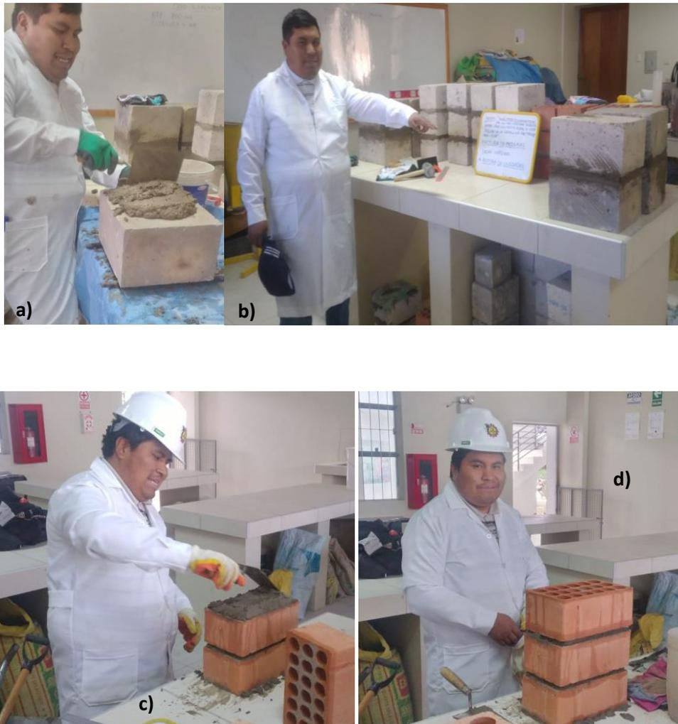
Nota: a) Se aprecia la construcción de pilas de sillar grande. b) Se aprecia el acabado final de las pilas. c) en la figura la construcción de los prismas de ladrillo d) en la figura los prismas de ladrillo acabados.
