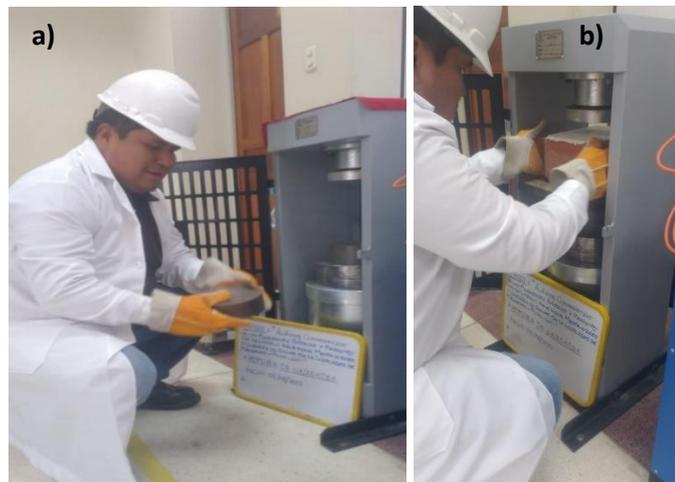
Nota: a) En la figura la colocación de los anillos en la máquina de compresión para la rotura de unidades. b) En la figura la colocación de la muestra de ladrillo King Kong en la máquina de compresión.
