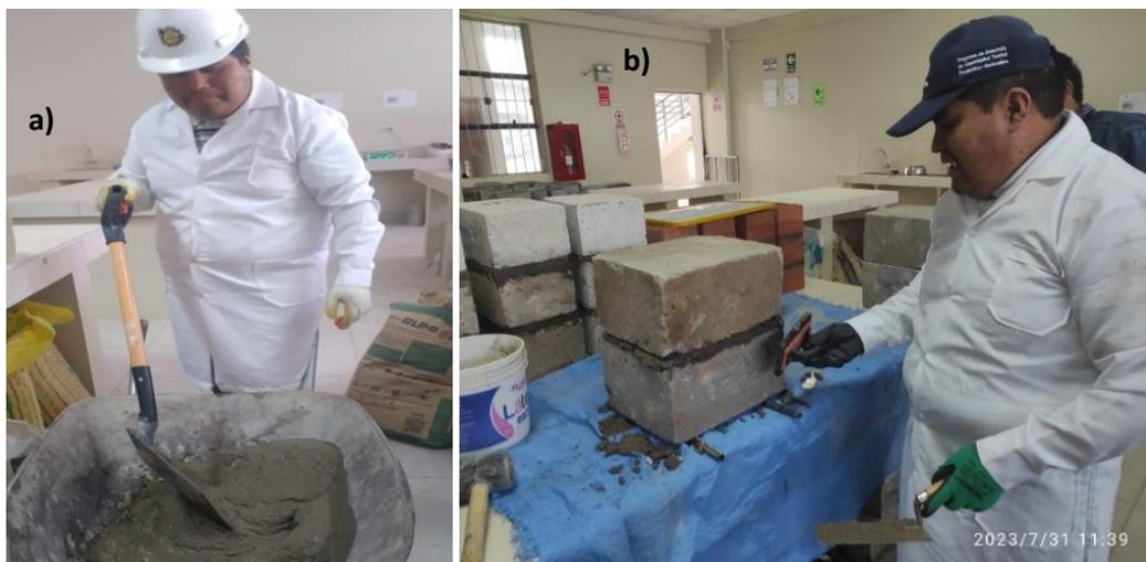
Nota: a) en la figura la preparación de la mezcla para albañilería. b) En la figura la elaboración de los prismas de sillar grande.
