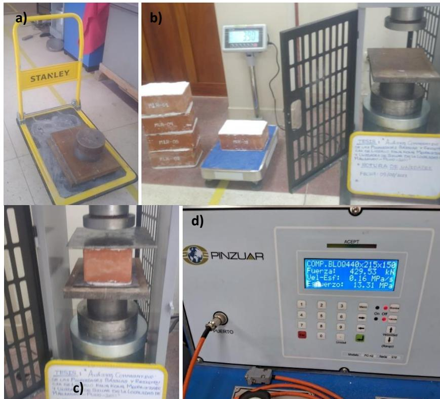
Nota: a) En la figura se aprecia los anillos y las placas utilizados en la máquina de compresión. b) En la figura vemos el ladrillo King Kong capeado listo para rotura junto a la máquina de compresión. c) En la figura la máquina de compresión con la muestra de ladrillo King Kong. d) En la figura la máquina de compresión automática marca Pinzuar haciendo la lectura.
