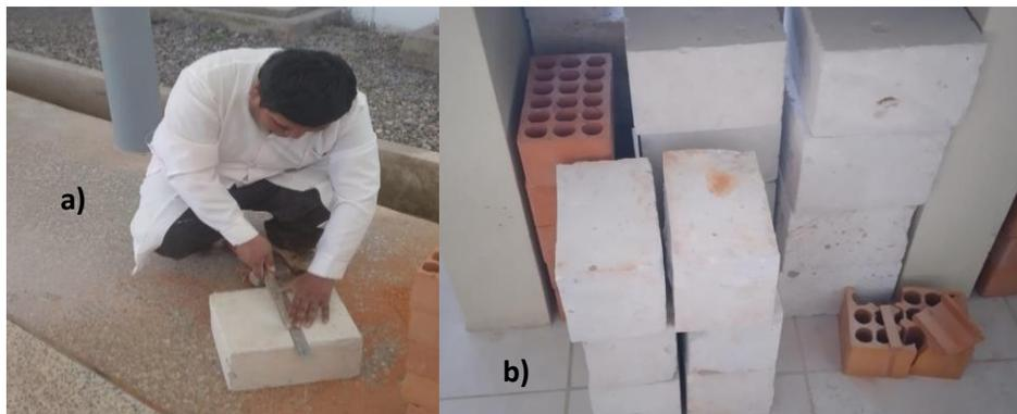
Nota: a) En la figura el corte que se realizó para obtener medias unidades. b) en la figura las muestras de sillar cortadas en medias unidades
