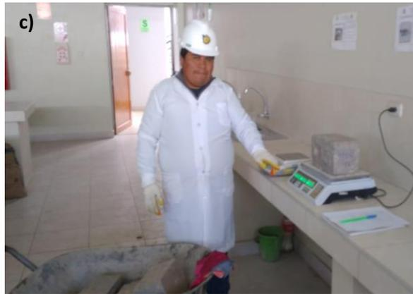
Nota: a) En la figura las muestras de sillar medias mitades para ensayo de absorción. b) En la figura las medias mitades de las unidades listas para sumergirse en el tanque y saturarlas por 24 horas. c) En la figura el tesista una vez saturado las muestras de sillar se pesan.
