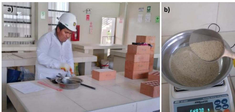
Nota: a) En la figura se observa al tesista realizando el ensayo de porcentaje de vacíos. b) En la figura una vez enrasado la arena graduada se procede a pesar la arena y así obtener el peso.
