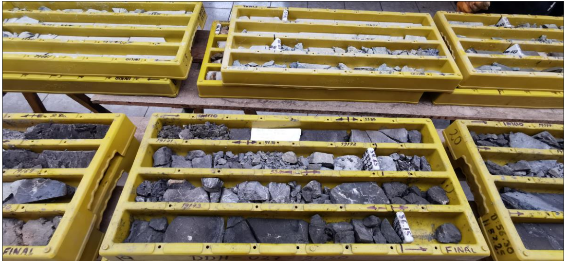
Figura 13: Testigo de perforación en zona de falla.
