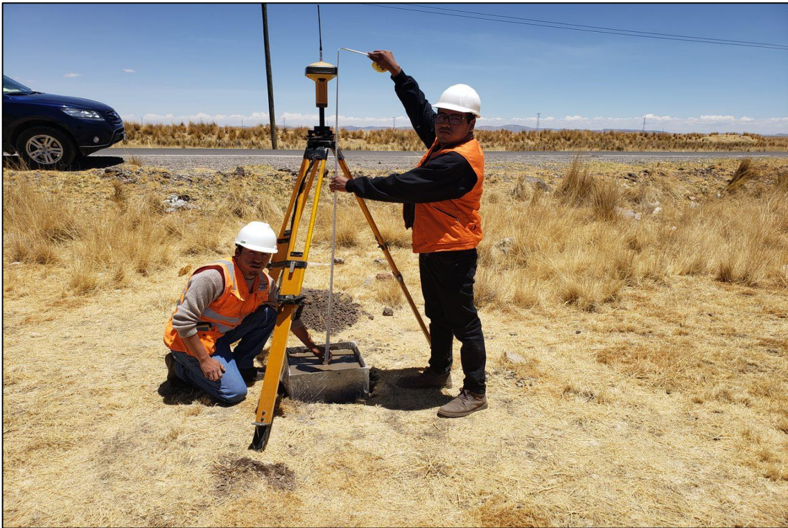
Fotografía 13. lectura de la altura del equipo.
