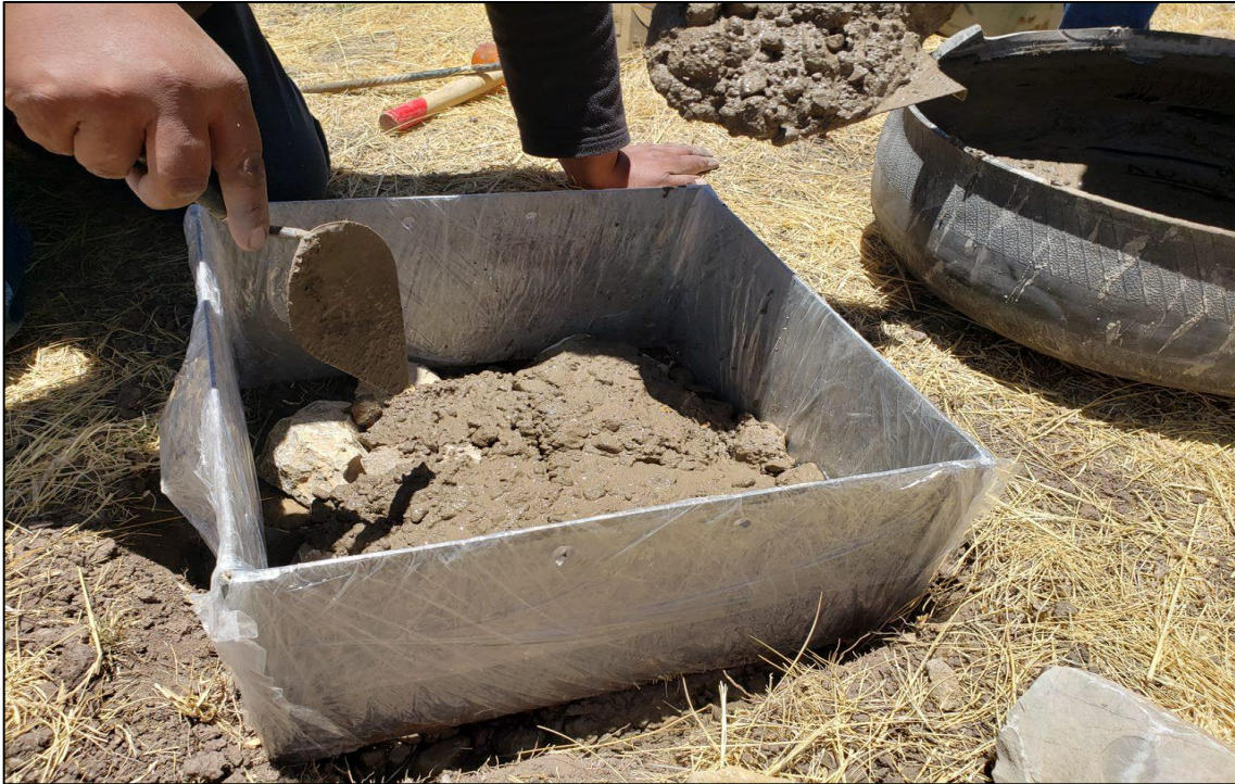
Fotografía 1. Vaciado de la mezcla en el molde.
