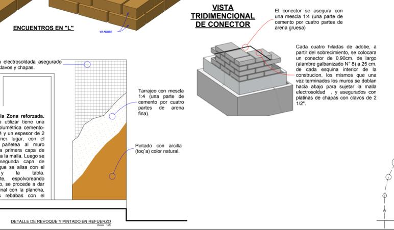
**Malla Electro soldada.** Esta malla está compuesta por alambre galvanizado de 1 mm, formando cocadas cuadrangulares de 3/4 de pulgada.
