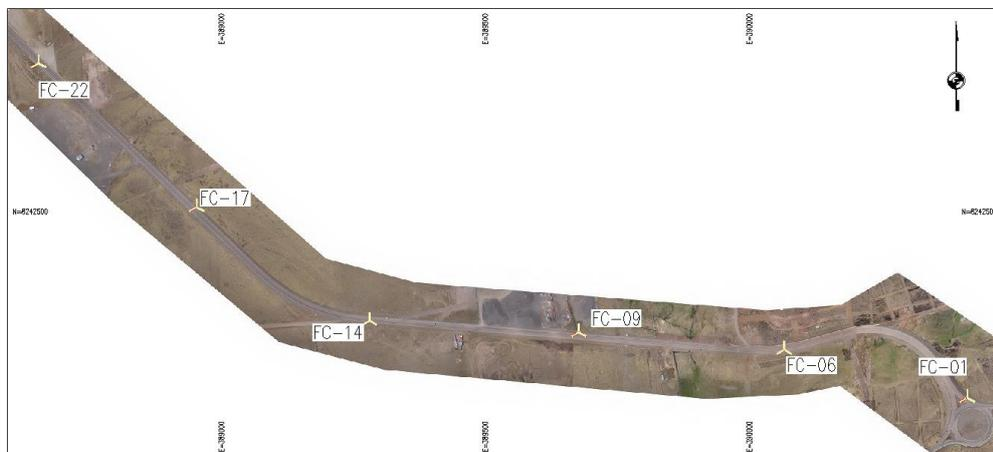
Nota. En la figura se muestra el Modelo 7 el cual está conformado por 6 puntos de control colocados de forma aleatoria con una distancia de separación de 400m entre cada Punto de control.
