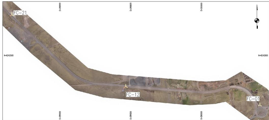
Nota. En la figura se muestra el Modelo 1 el cual está conformado por 3 puntos de control colocados de forma aleatoria con una distancia de separación de 1000m entre cada Punto de control.
