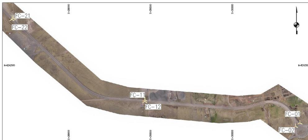
Nota. En la figura se muestra el Modelo 2 el cual está conformado por 6 puntos de control colocados en ambos lados de la vía con una distancia de separación de 1000m entre cada Punto de control.
