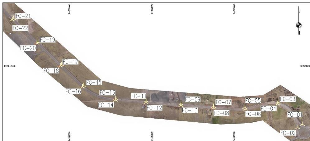
Nota. En la figura se muestra el Modelo 10 el cual está conformado por 22 puntos de control colocados en ambos lados de la vía con una distancia de separación de 200m entre cada Punto de control.
