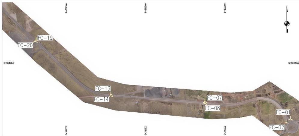
Nota. En la figura se muestra el Modelo 6 el cual está conformado por 8 puntos de control colocados en ambos lados de la vía con una distancia de separación de 600m entre cada Punto de control
