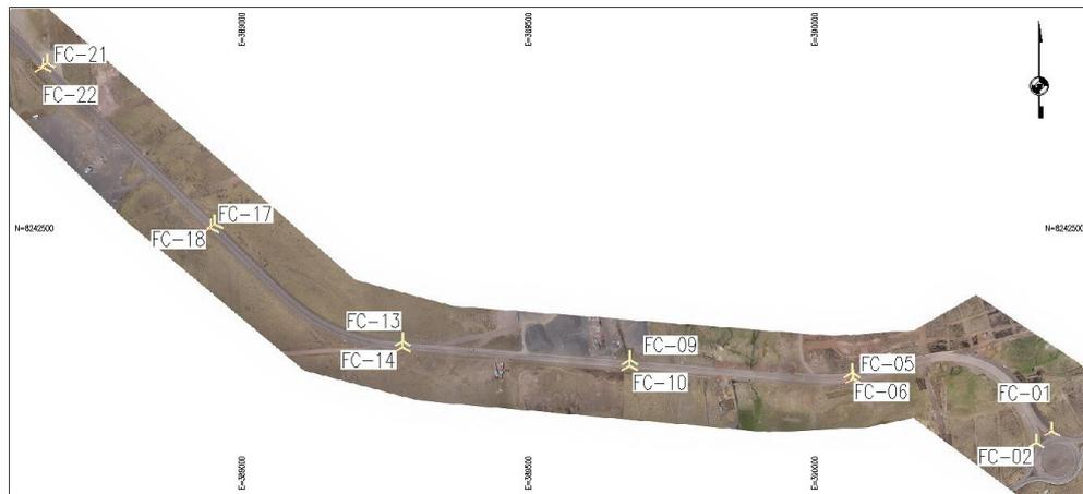
Nota. En la figura se muestra el Modelo 8 el cual está conformado por 12 puntos de control colocados en ambos lados de la vía con una distancia de separación de 400m entre cada Punto de control.
