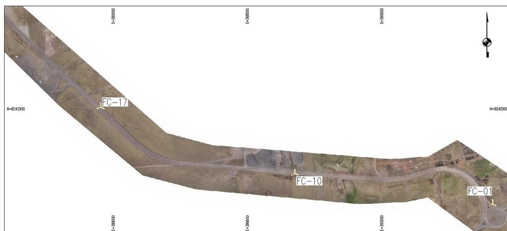
Nota. En la figura se muestra el Modelo 3 el cual está conformado por 3 puntos de control colocados de forma aleatoria con una distancia de separación de 800m entre cada Punto de control.
