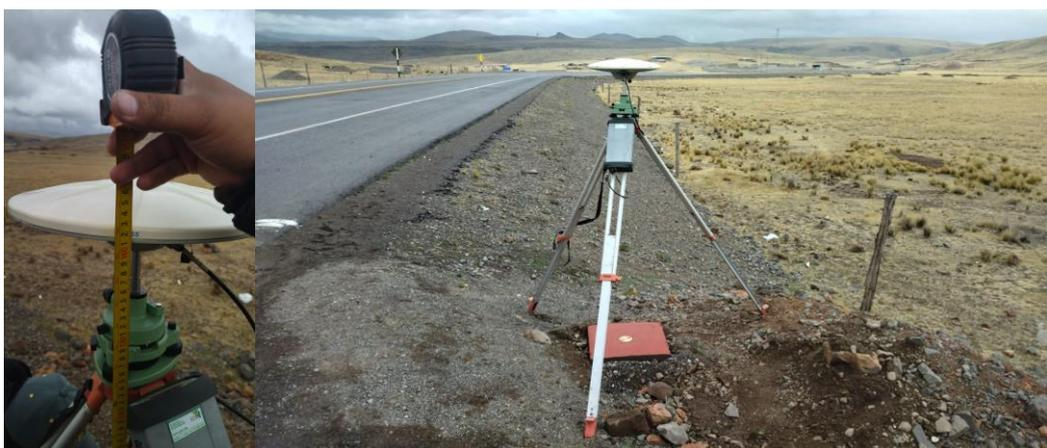
Nota: En la figura se muestra la Medición y posicionamiento del Punto PCG-01 Método Estático.
