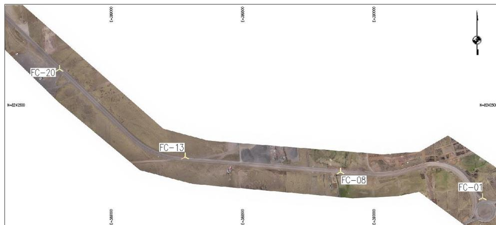
Nota. En la figura se muestra el Modelo 5 el cual está conformado por 4 puntos de control colocados de forma aleatoria con una distancia de separación de 600m entre cada Punto de control.
