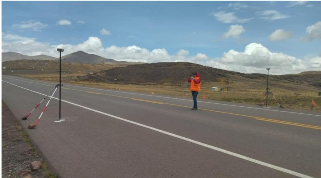
*Nota.* En la figura se muestra la toma de datos de Puntos de Control en Modo Estático Rápido.
