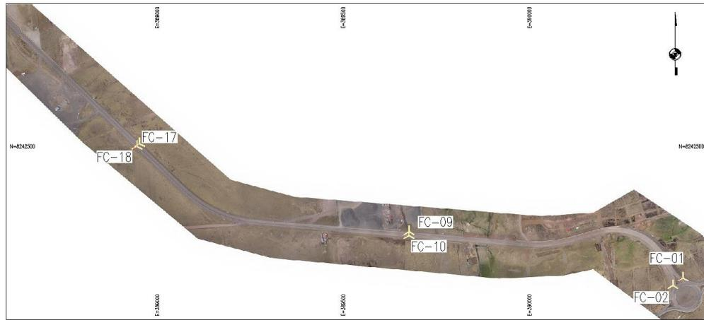
Nota. En la figura se muestra el Modelo 4 el cual está conformado por 6 puntos de control colocados en ambos lados de la vía con una distancia de separación de 800m entre cada Punto de control.
