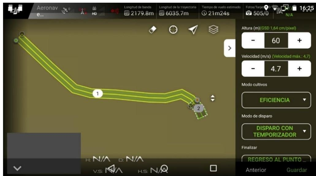
Nota: En la figura se muestra el plan de vuelo con el programa DJI GO 4.
