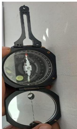
Brújula Marca Brunton Modelo-F5006LM, instrumento para orientar la estación meteorológica profesional
