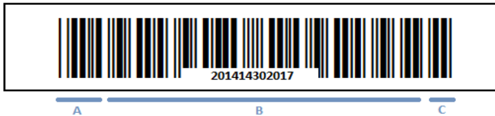
Figura 2. Código de barras creado utilizando un programa personalizado, en conformidad con las normativas necesarias para su identificación. (A) BarCode Head, señala el punto de partida. (B) BarCode Body, representa el contenido, que en este caso corresponde al código 201414302017. (C) BarCode Checksum, señala el final del código de barras
