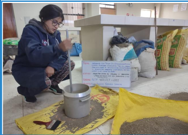
IMAGEN 19: PESO UNITARIO DEL AGREGADO FINO - COMPACTADO NTP. 400.017
