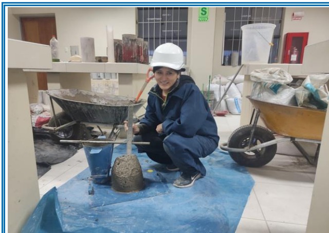
IMAGEN 53: ASENTAMIENTO DEL CONCRETO CON EL CONO DE ABRAMS NTP 339.035
