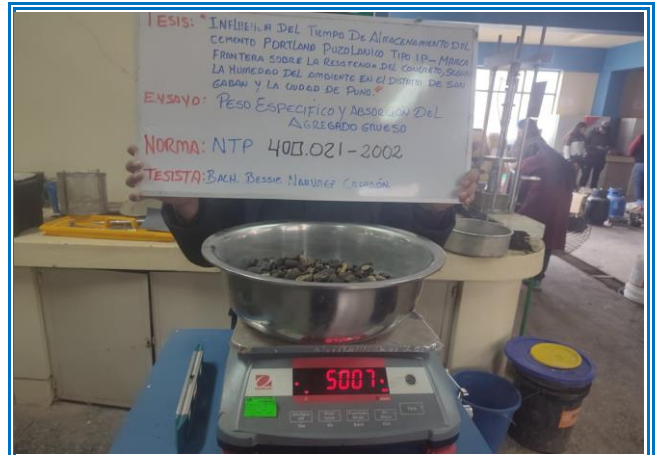
IMAGEN 36: PESO ESPECÍFICO Y ABSORCIÓN AGREGADO GRUESO - PESO SSS NTP. 400.021
