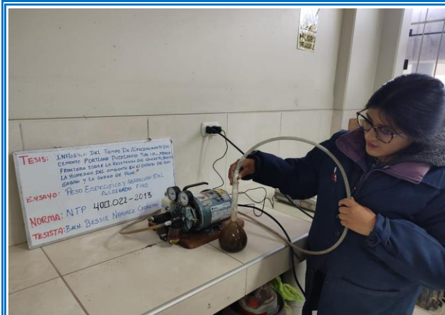
IMAGEN 31: PESO ESPECÍFICO Y ABSORCIÓN AGREGADO FINO - EXTRACCIÓN DE VACIOS DE AIRE NTP. 400.022
