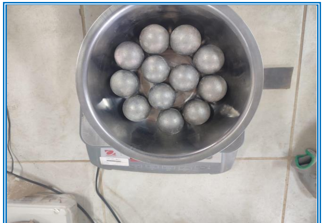
IMAGEN 42: RESISTENCIA AL DESGASTE EN LA MÁQUINA DE LOS ÁNGELES-ESFERAS DE ACERO NTP. 400.019
