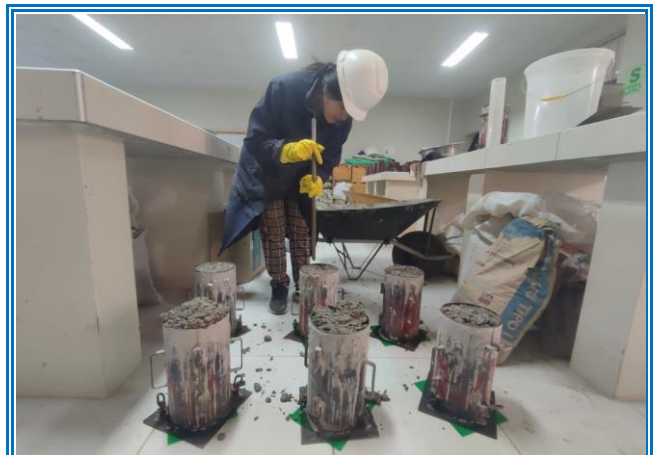
IMAGEN 54: ELABORACIÓN DE PROBETAS DE CONCRETO - COMPACTADO NTP 339.183
