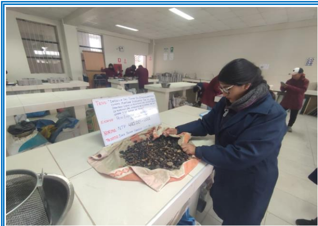
IMAGEN 35: PESO ESPECÍFICO Y ABSORCIÓN AGREGADO GRUESO - SECADO DE PELICULA DE AGUA NTP. 400.021
