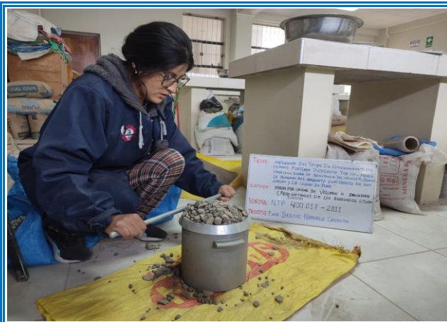
IMAGEN 23: PESO UNITARIO DEL AGREGADO GRUESO - ENRASADO NTP. 400.017
