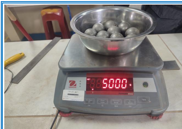
IMAGEN 43: RESISTENCIA AL DESGASTE EN LA MÁQUINA NTP. 400.019 DE LOS ÁNGELES-ESFERAS DE ACERO
