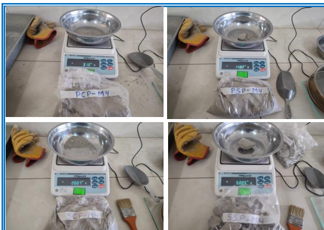
IMAGEN 47: ANÁLISIS DE FINURA DEL CEMENTO ASTM C-184 ALMACENADO - PESO DE LAS MUESTRAS
