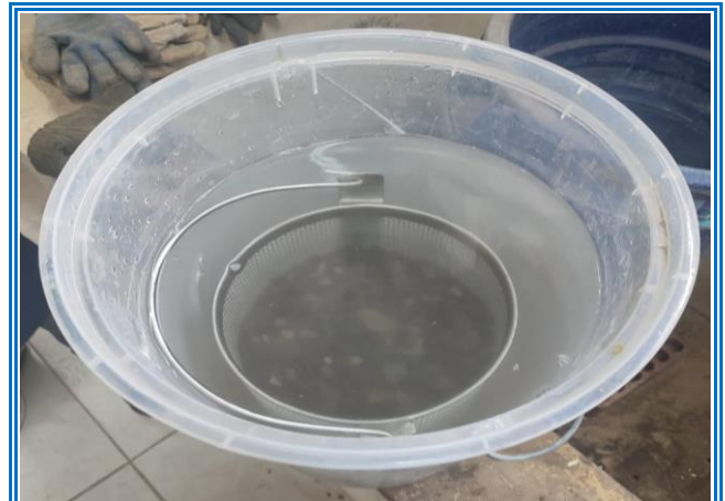
IMAGEN 34: PESO ESPECÍFICO Y ABSORCIÓN AGREGADO GRUESO - SUMERGIDO POR 24 HORAS NTP. 400.021
