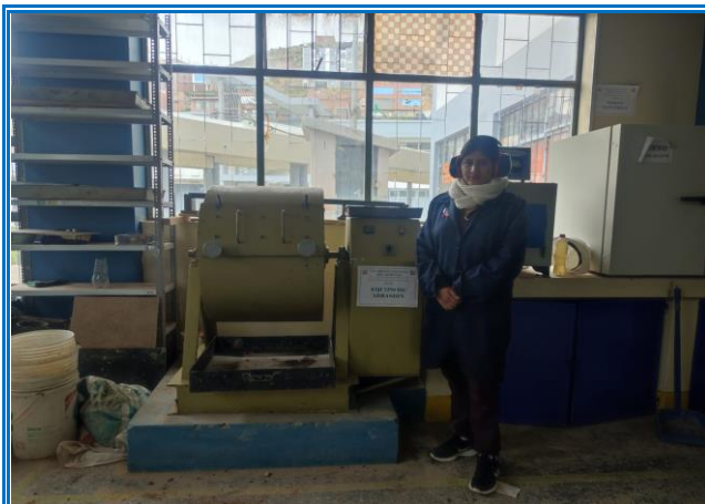
IMAGEN 41: RESISTENCIA AL DESGASTE EN LA MÁQUINA DE LOS ÁNGELES NTP. 400.019
