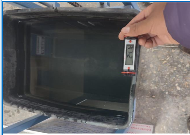
IMAGEN 37: PESO ESPECÍFICO Y ABSORCIÓN AGREGADO GRUESO - TEMPERATURA DEL AGUA NTP. 400.021
