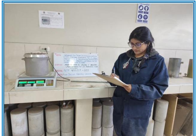
IMAGEN 24: PESO UNITARIO DEL AGREGADO GRUESO - PESO DE LA MUESTRA NTP. 400.017
