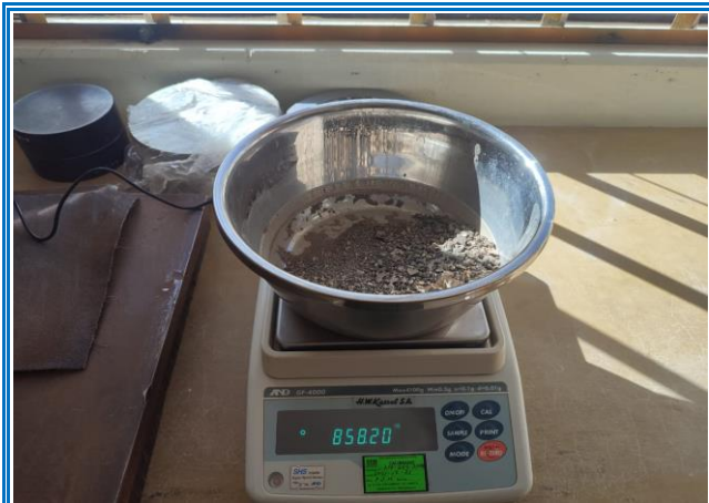
IMAGEN 33: PESO ESPECÍFICO Y ABSORCIÓN AGREGADO FINO - PESO SECO NTP. 400.022
