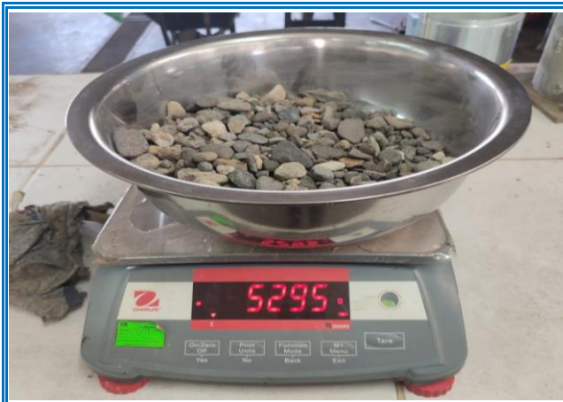
IMAGEN 39: PESO ESPECÍFICO Y ABSORCIÓN AGREGADO GRUESO - PESO SECO NTP. 400.021
