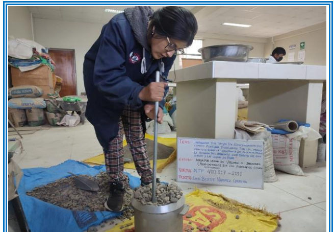
IMAGEN 22: PESO UNITARIO DEL AGREGADO GRUESO - COMPACTADO NTP. 400.017
