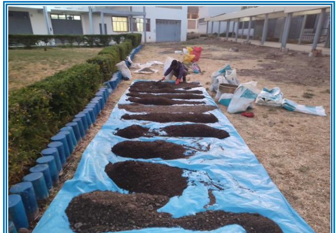
IMAGEN 12: PREPARACIÓN DE LA MUESTRA, AGREGADO FINO - CUARTEO. NTP. 400.010
