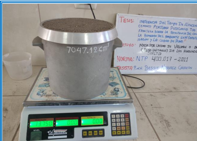
IMAGEN 21: PESO UNITARIO DEL AGREGADO FINO - PESO DE LA MUESTRA NTP. 400.017
