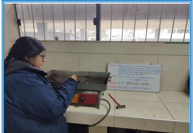
IMAGEN 26: NTP. 400.022 PESO ESPECÍFICO Y ABSORCIÓN AGREGADO FINO - SECADO EN ESTUFA
