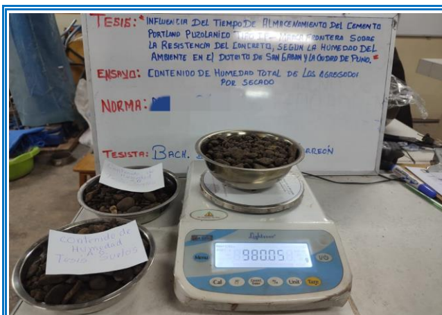
IMAGEN 45: CONTENIDO DE HUMEDAD DEL AGREGADO NTP. 339.185 GRUESO
