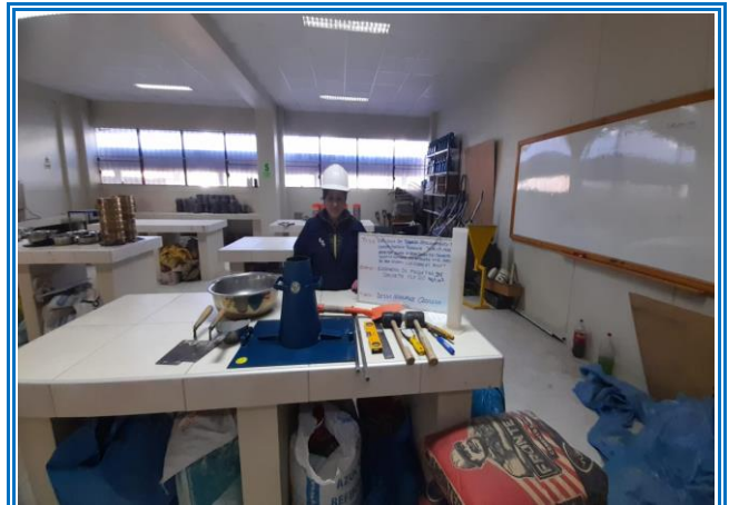
IMAGEN 50: ELABORACIÓN DE PROBETAS DE CONCRETO NTP 339.183
