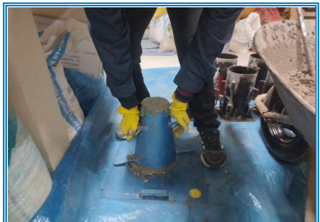
IMAGEN 52: ASENTAMIENTO DEL CONCRETO CON EL CONO DE ABRAMS NTP 339.035
