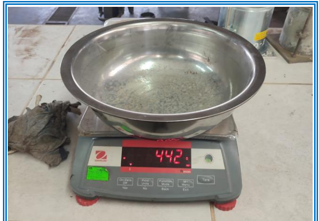
IMAGEN 40: PESO ESPECÍFICO Y ABSORCIÓN AGREGADO GRUESO - PESO TARA NTP. 400.021
