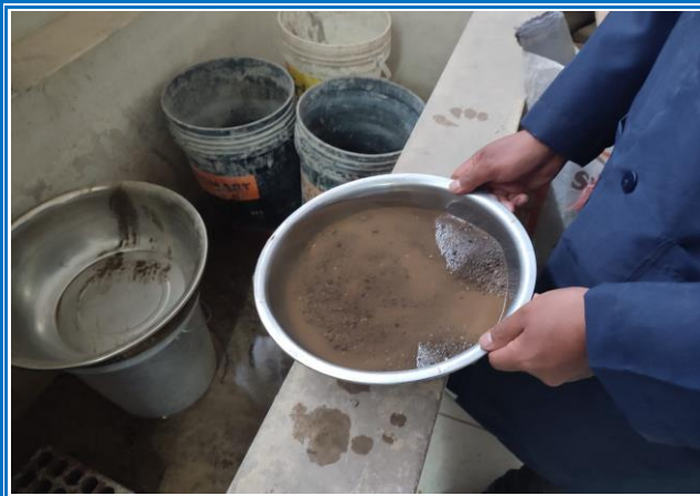
IMAGEN 25: NTP. 400.022 PESO ESPECÍFICO Y ABSORCIÓN AGREGADO FINO - SUMERGIDO POR 24 HORAS
