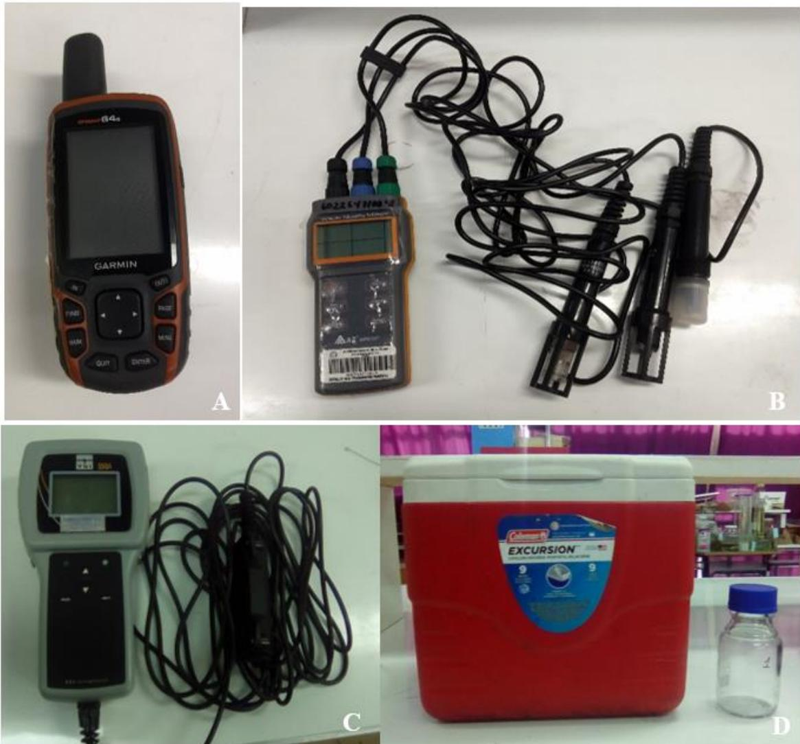
**Figura 13.** Equipos para toma de muestras de agua: A. GPS B y C Equipos para análisis de calidad de agua D. Cooler para transporte de muestras de agua.
