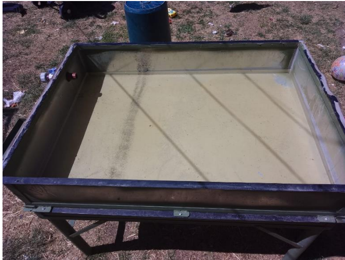
Fotografía 9: Acumulación de sedimentos de sales en la bandeja
