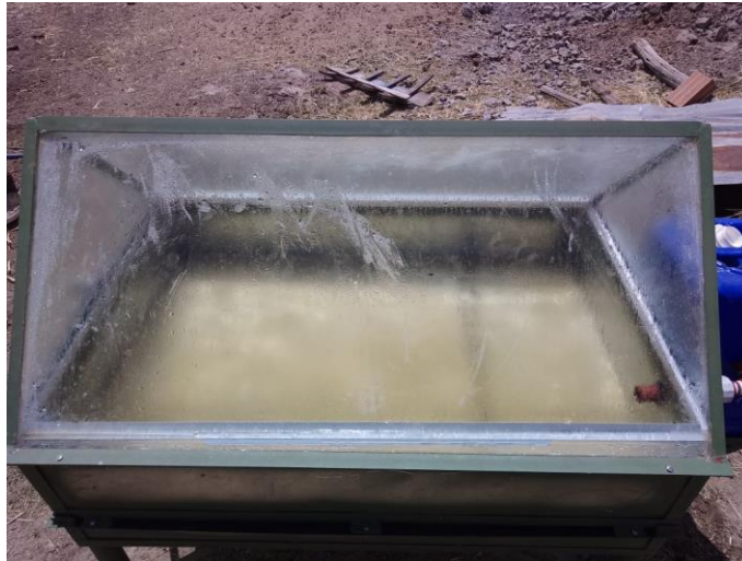
Fotografía 7: Condensación del agua por las paredes del destilador solar
