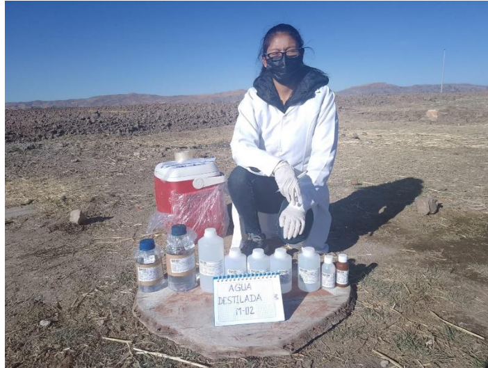
Fotografía 11: Muestreo de agua procesada (M-02) para su análisis en laboratorio BHIOS LABORATORIO
