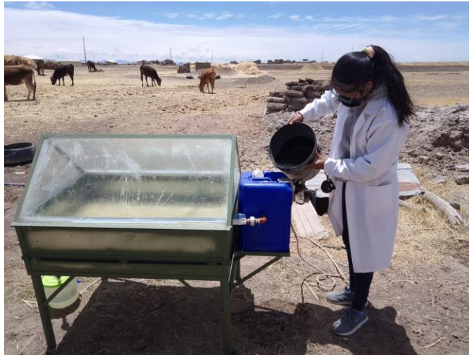
Fotografía 5: Abastecimiento al tanque de almacenamiento de agua subterránea salada
