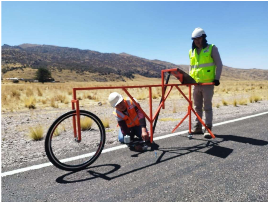
Fotografía N ° 09. Calibración del rugosímetro Merlin y toma de datos para el cálculo del factor de corrección.
