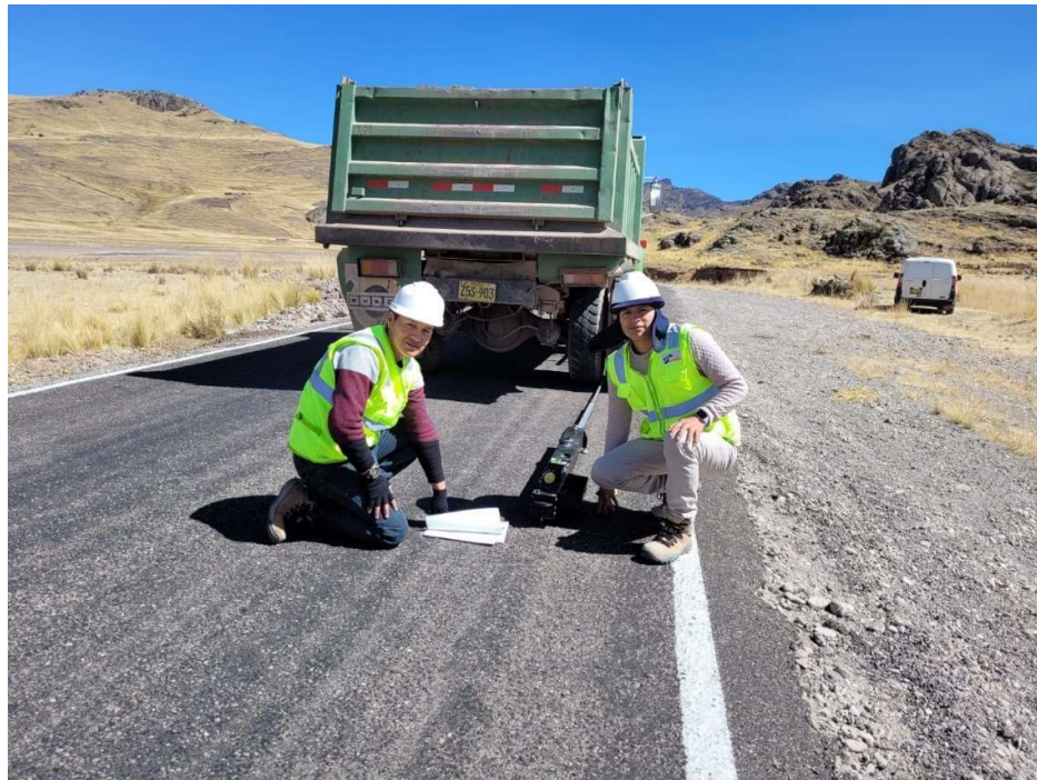
Fotografía N ° 16. Equipo de trabajo en campo para ensayo de Viga Benkelman.
