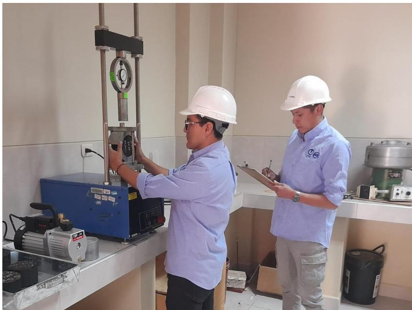
Nota: testigos de concreto asfáltico ensayadas en el equipo Marshall para hallar estabilidad y flujo
