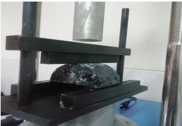
Nota: espécimen modificado con 4% de fibra de acero, generando fisuras arbitrarias
