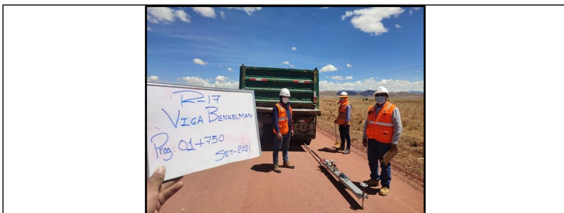
FOTOGRAFÍA 17: Verificación de los tramos estabilizados con terraplén por medio de ensayo de viga Benkelman del km. 01+750 al km. 02+250.
