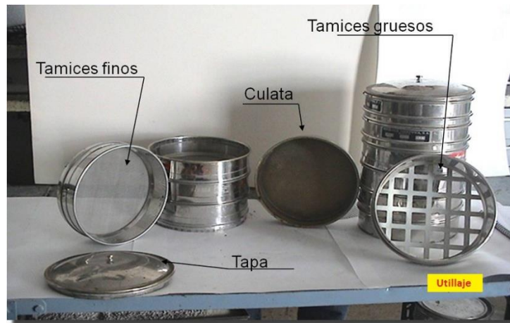
Figura 9 Equipos para ensayo de granulometría.
