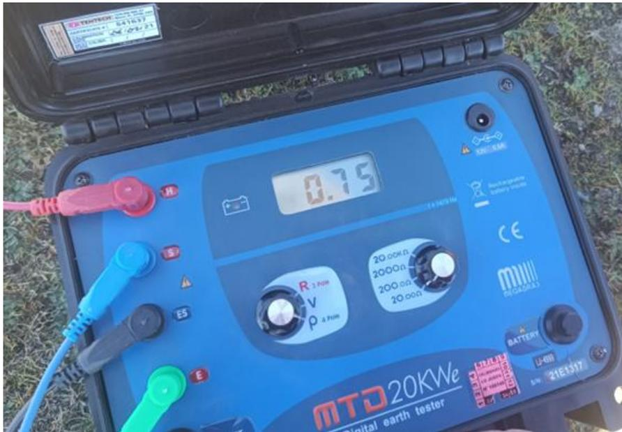
Figura 24. Medición de la resistividad método Werner
