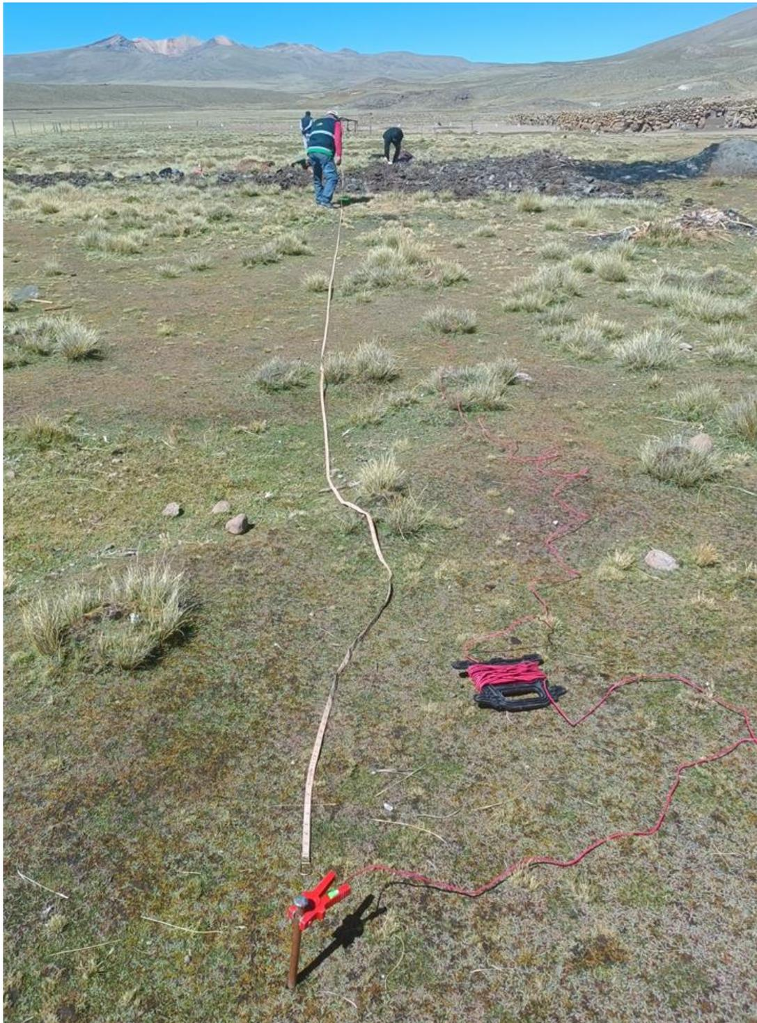
*Figura 22.* Medición de la resistividad trayectoria N°1 norte
