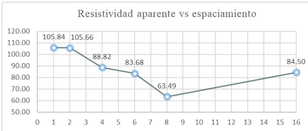
Figura 26. Resistividad aparente vs espaciamiento trayectoria este
