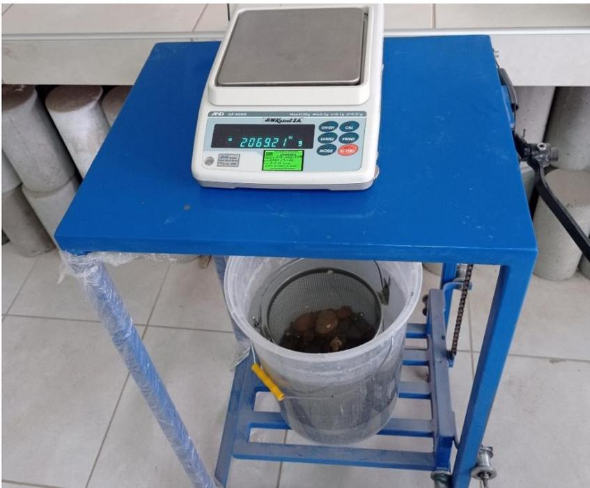
Nota: En la imagen se puede observar el pesado del agregado grueso en S.S.S. sumergido en la canastilla.
