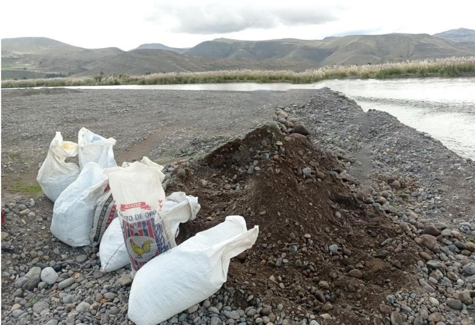
Nota: En la figura se puede apreciar la extracción de agregados de la cantera de Cabanillas manualmente.
