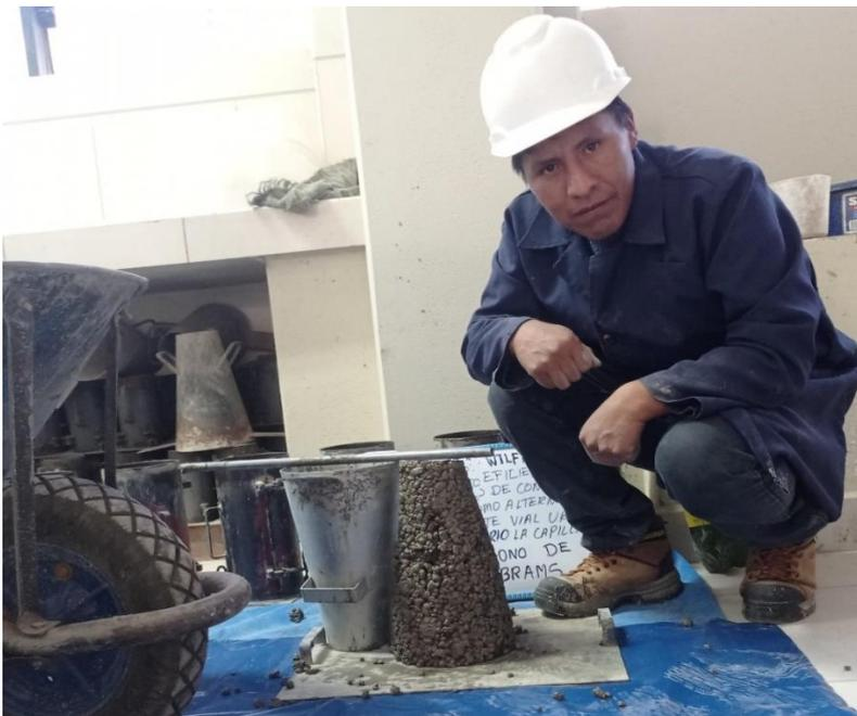
Nota: Se observar el asentamiento en la figura de cono Slump.
