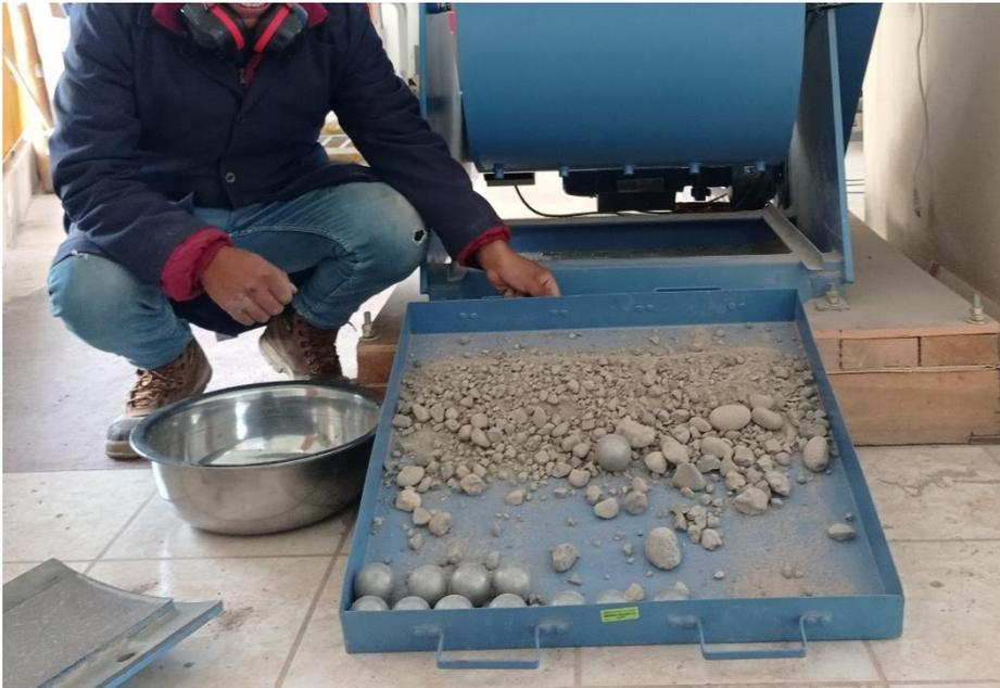
Nota: Se muestra en la figura la degradación de los agregados al efectuar la prueba de abrasión de los ángeles.
