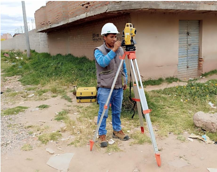
Nota: En la imagen se muestra la configuración de la estación total para realizar el levantamiento topográfico.
