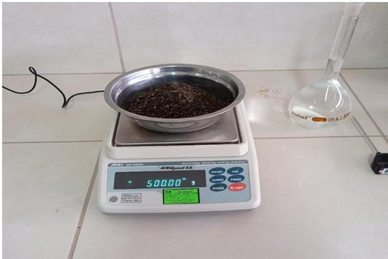
Nota: En la imagen se puede apreciar el pesado del material S.S.S. de 500 gr.
