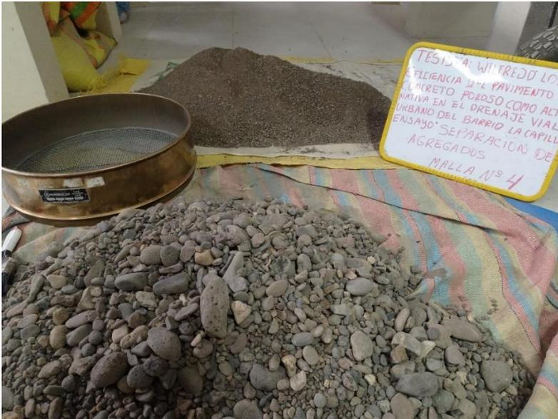
Nota: Se aprecia en la figura, separación de agregado fino y grueso utilizando el tamiz N° 4.
