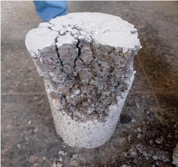
Nota: Se observa en la figura, la falla del espécimen como bien formado en ambos extremos.
