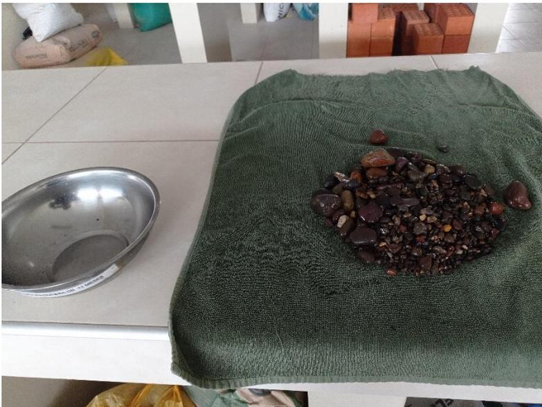
Nota: En la imagen se puede observar el estado S.S.S. del agregado grueso.
