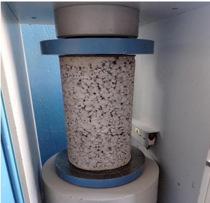
Nota: En la figura se puede apreciar espécimen de concreto poroso cargado a la máquina de compresión axial.
