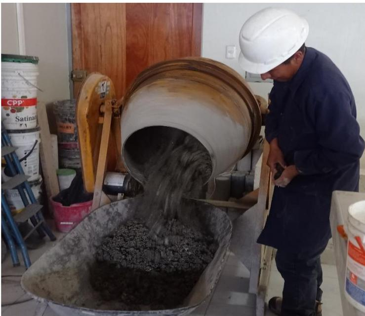
Nota: se observar en la figura concreto poroso después de haber sido mezclado por un tiempo de 3 minutos.
