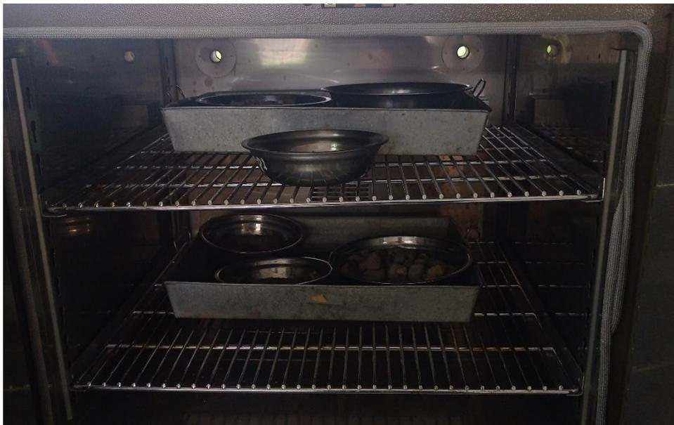
Nota: En la imagen se puede apreciar puesto al horno para determinar su contenido de humedad para los agregados.
