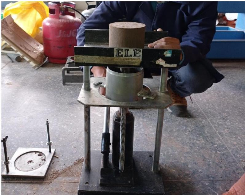
Nota: Se muestra en la figura la extracción del material compactado del molde con la extractora de especímenes.
