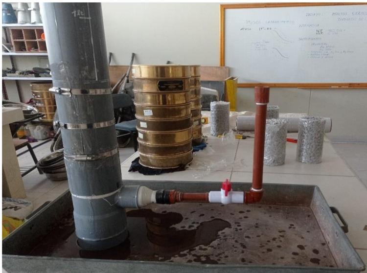
Nota: En la figura se puede apreciar el permeámetro adaptado de la norma (ACI-522R-10, 2015), se construyó el permeámetro utilizando tubo de 4", 3 abrazadera, un llave de paso, tubo de 1/2", reductor de 2" a 1/2", codo 1/2" y teflón, las dimensiones se cumplieron según la figura 5.
