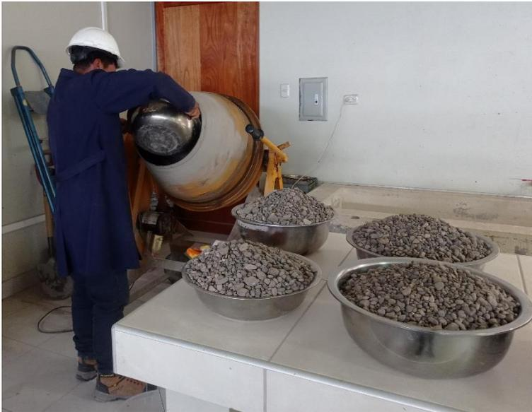
Nota: Se muestra en la figura agregando, agua, cemento y agregados a la mezcladora de concreto.
