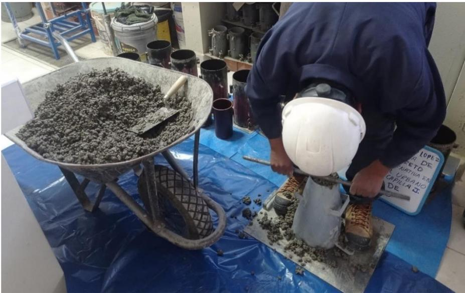
Nota: Se muestra el procedimiento de varillado en el cono de Abrams en donde consistió en dar 25 golpes aleatoriamente en cada capa.
