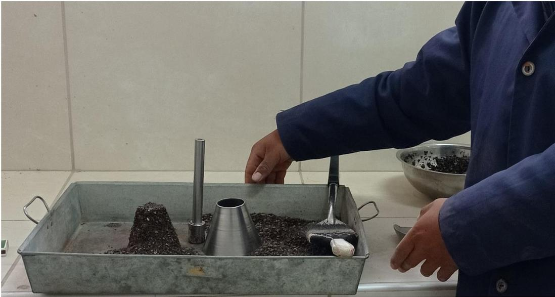
Nota: En la imagen se puede apreciar el primer desmoronamiento se observa el estado de S.S.S.
