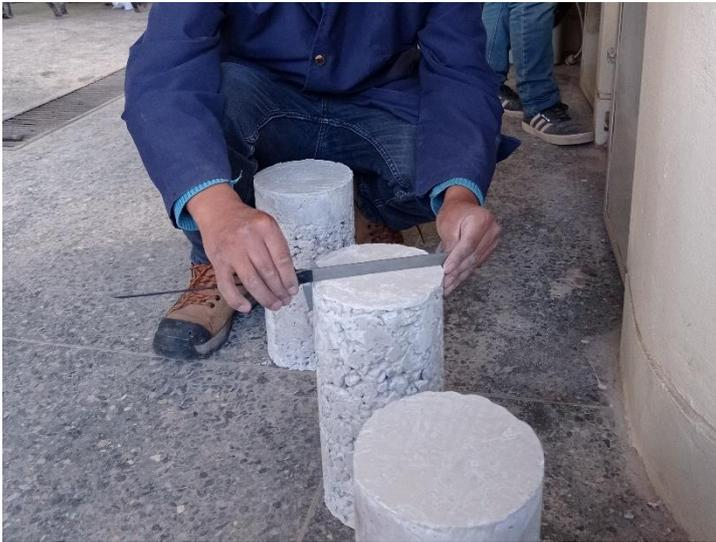
Nota: Se observa en la figura la toma de medidas del espécimen de H-8 con 15% de agregado fino.
