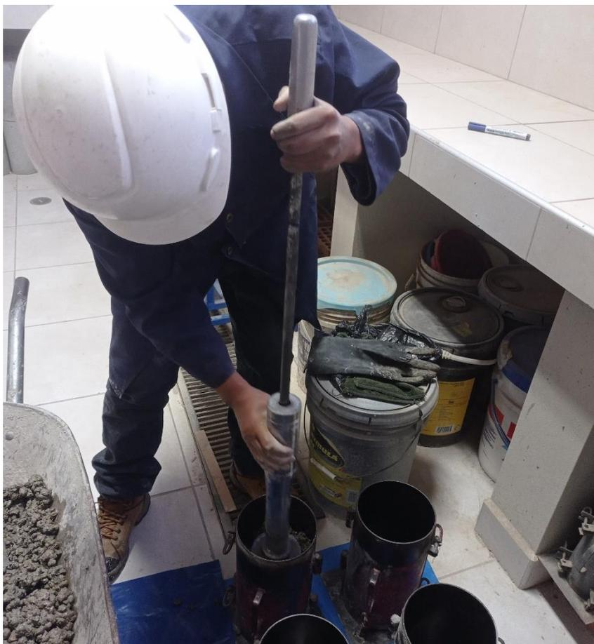
Nota: Se observa la compactación con un martillo de proctor modificado en la figura para compactar ligeramente.
