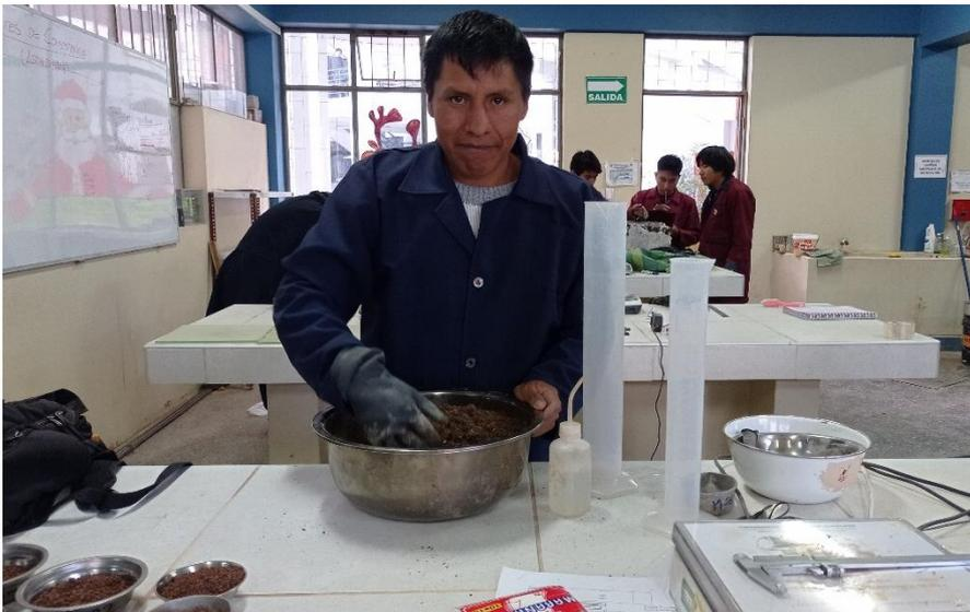
Nota: Se muestra en la figura el mezclado y saturación con el contenido de humedad óptimo para efectuar el ensayo de CBR.
