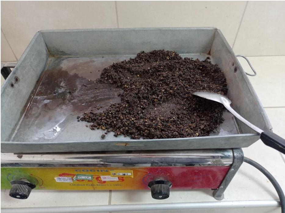
Nota: En la imagen se aprecia el secado del material para alcanzar el estado de saturado superficialmente seco.
