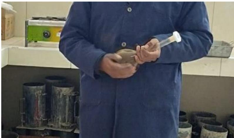
Nota: Se puede apreciar en la imagen el proceso de eliminación de aire girando constantemente durante 15 minutos.
