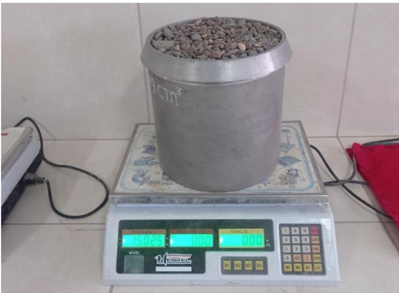
Nota: Se observa el procedimiento de pesado de agregado grueso en la olla de Washington.
