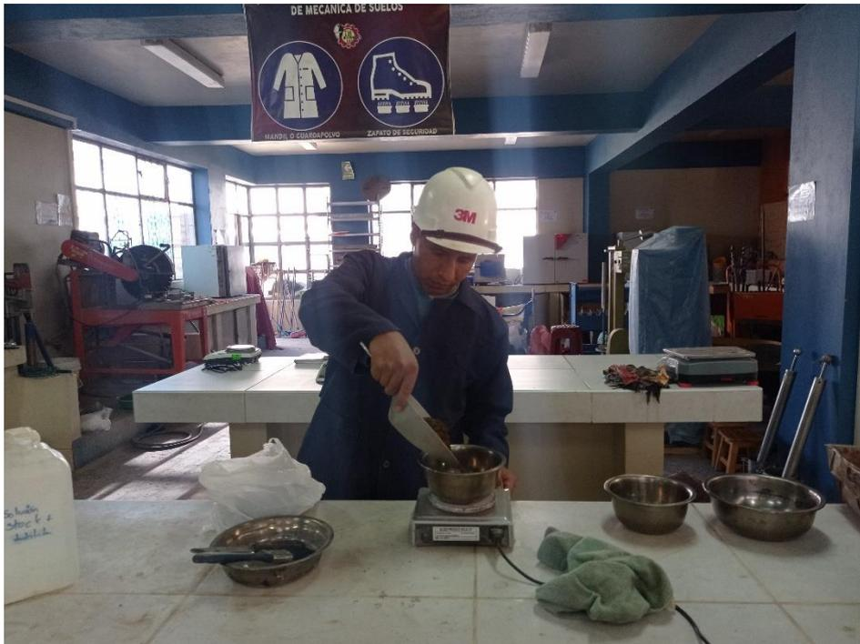
Nota: Se observa en la figura el pesado del material húmedo en tres recipientes y luego se coloca al horno durante 24 horas.
