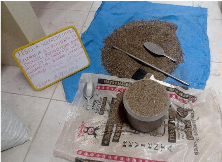
Nota: Se muestra en la figura varillado en el ensayo de peso unitario para el agregado fino.
