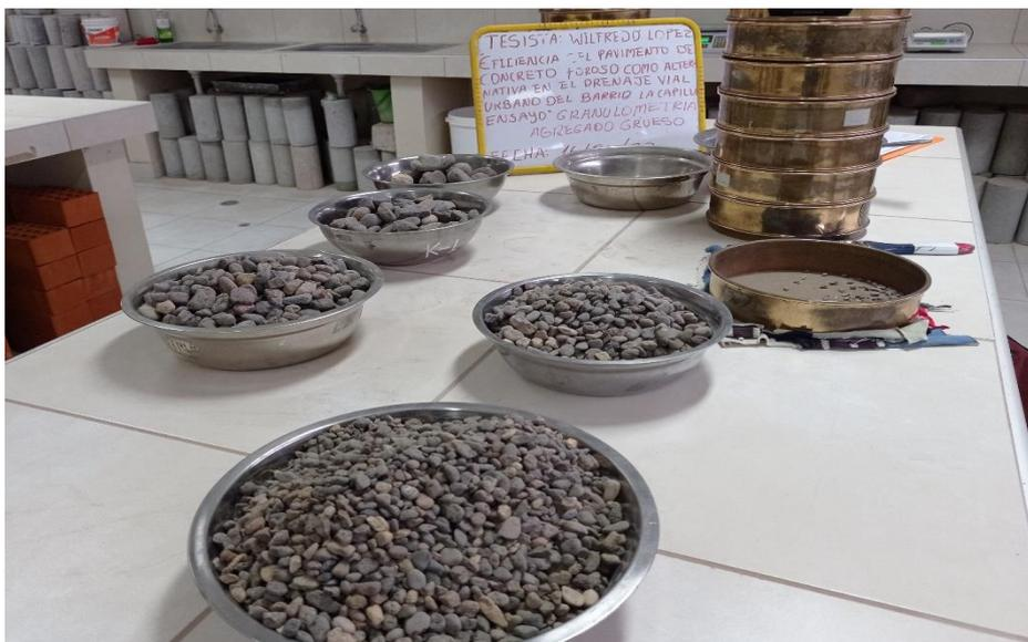
Nota: En la imagen se aprecia material retenido en cada tamiz.
