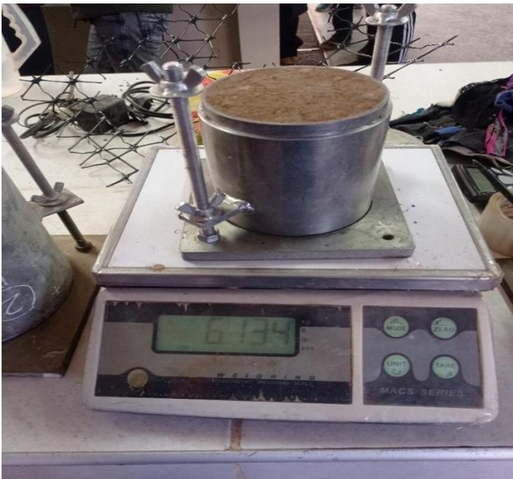
Nota: En la imagen se muestra el peso del molde más el peso del material compactado.
