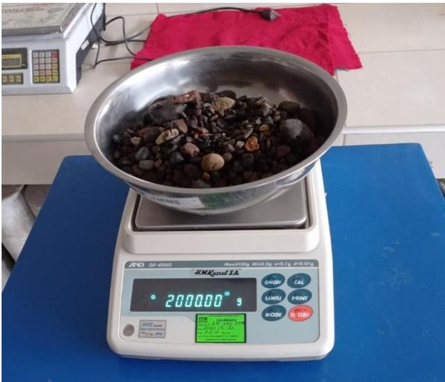
Nota: Se puede apreciar en la figura pesado del agregado grueso en S.S.S.
