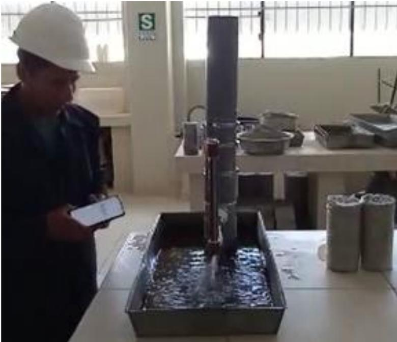
Nota: En la figura se efectúa la infiltración a través del permeámetro de testigos de concreto poroso y es controlado el tiempo con un cronometro.
