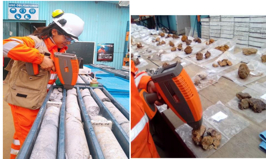
Figura 8. Análisis de muestras de testigos de perforación diamantina y muestras de superficie con equipo Terraspec Halo.
