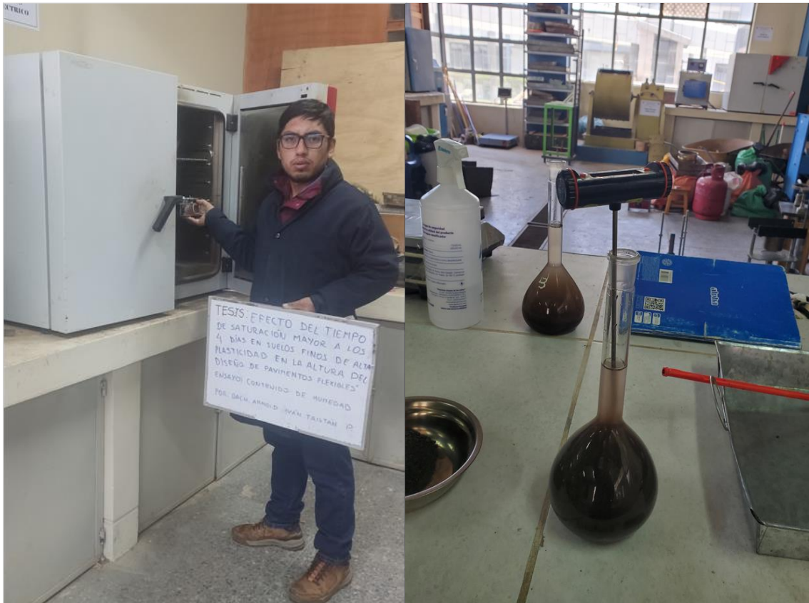
Fotografía 6: Saturación en CBR
