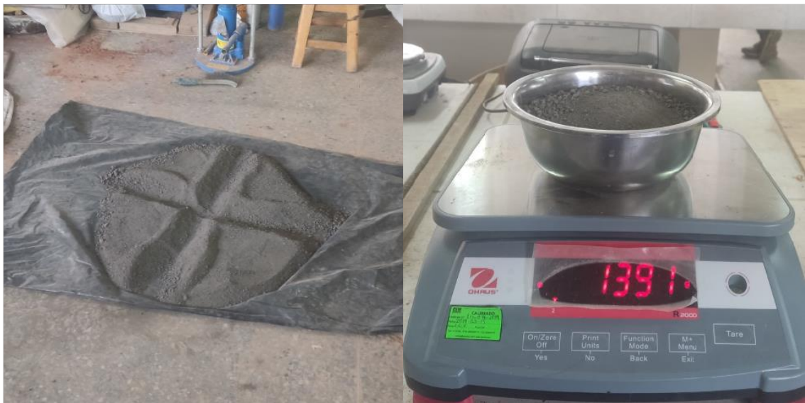
Fotografía 8: Cuarteo de material
