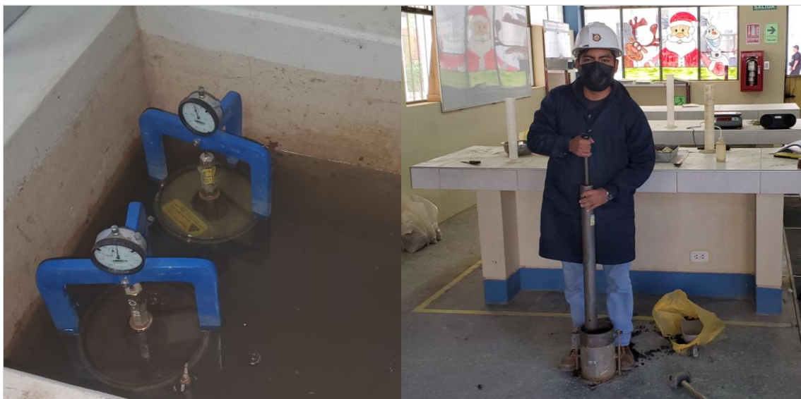
Fotografía 6: Saturación en CBR
