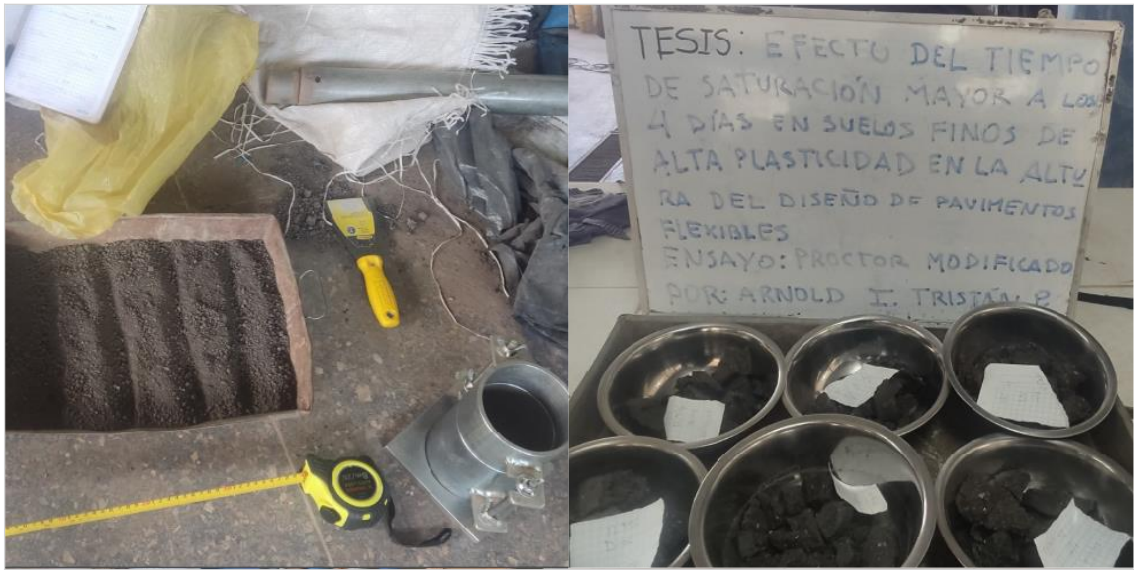
Fotografía 8: Cuarteo de material
