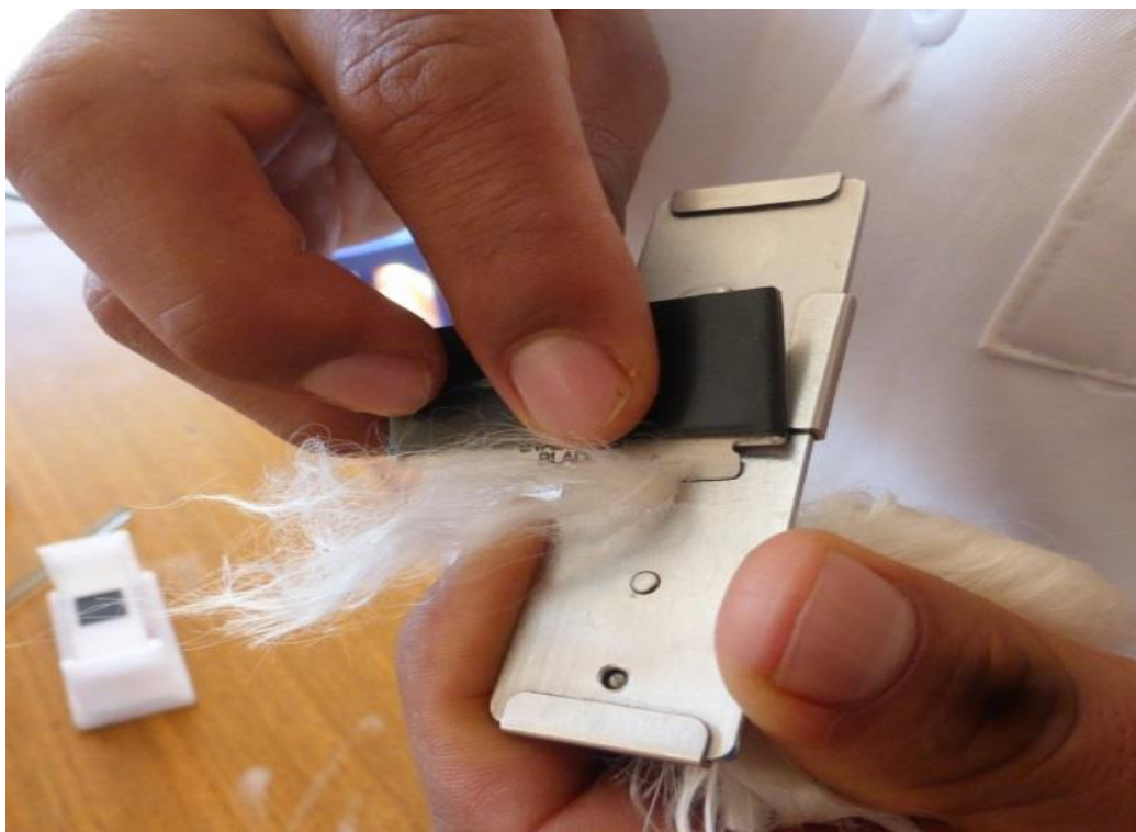
Fotografía 3. Corte de fibra en micrótopo de Hardy
