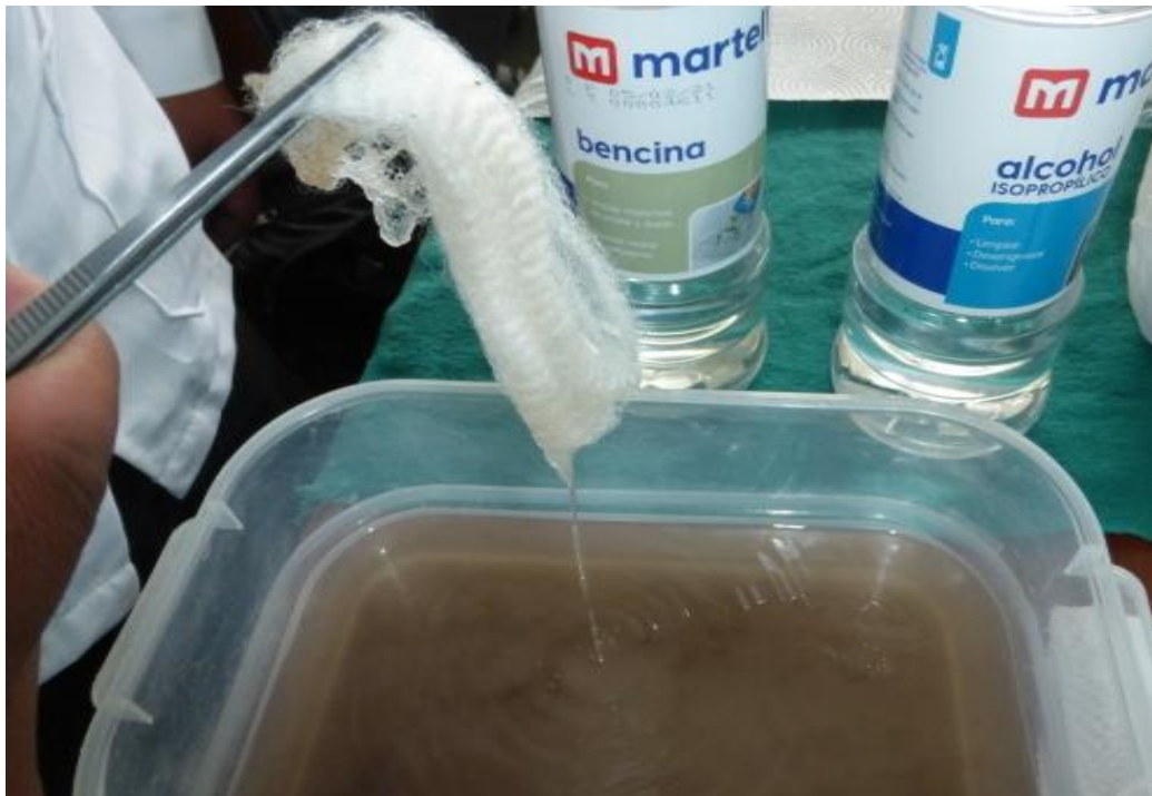
Fotografía 2. Lavado de muestras de fibra con alcohol isopropilico y bencina.
