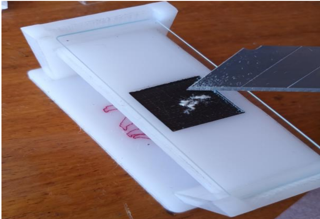
Fotografía 5. (a) Agregado de aceite de inmersión, (b) homogenizado y rotulado de láminas (c) para el análisis en FIBER MED.
