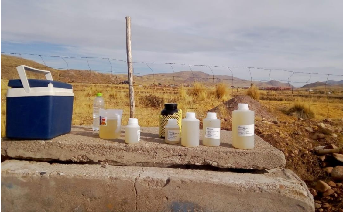
Figura 24. Recolección de muestra de los cinco puntos de la laguna de oxidación
