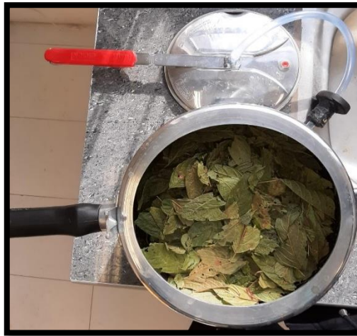
Figura 8. Muestra de achiwa ( Cybistax antisiphilitica ) dispuesta en la olla presión para la obtención de aceites esenciales.
