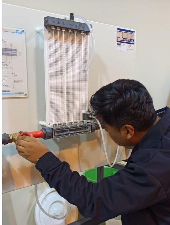
Figura 24. Midiendo presiones estáticas en el tubo de Venturi del módulo
