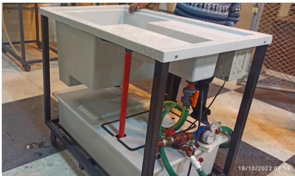
Figura 19. Módulo básico de suministro de agua.
