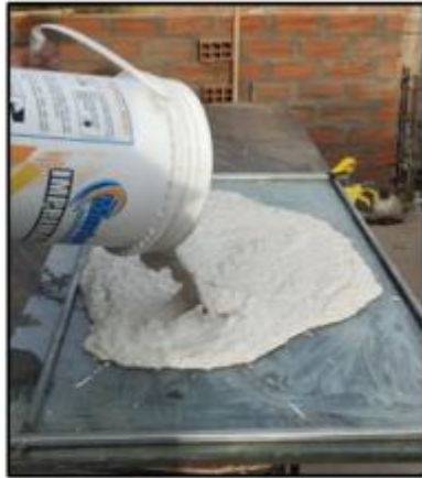
(d) Vaceado de la mezcla hacia el molde
