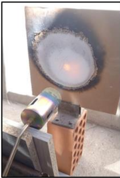
(a) Ensayo de la capacidad de resistencia al fuego del panel
