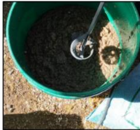
(b) Batido con mezclador eléctrico.
