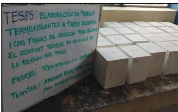
(a) Muestras para ensayo a Compresión
