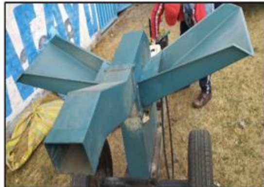
(b) Maquina Trilladora de Forraje de 10 HP.
