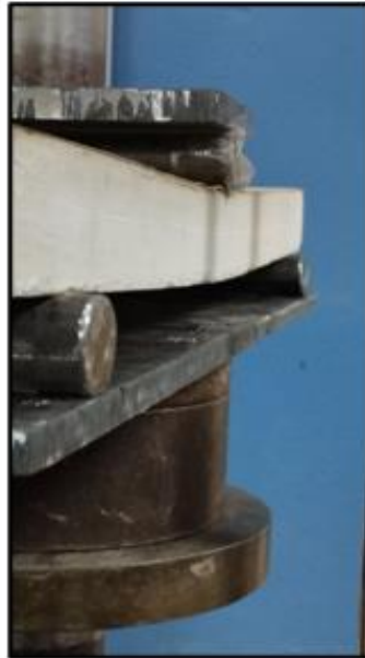
(a) Planchas de acero y puntos de apoyo.
