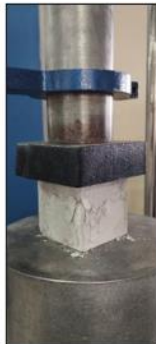
(c) Ensayo de Compresión en ruptura
