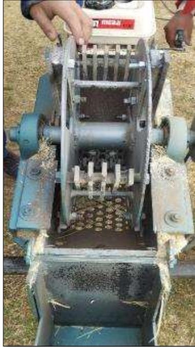
**FOTO 03.** VISTA DE LAS PALETAS DE CABEZAL DE TRILLADORA PARA OBTENCION DE FIBRAS DE STIPA ICHU.
