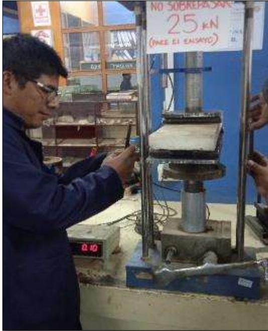
**FOTO 37.** VISTA DE TOMA DE DATOS DEL ENSAYO DE RESITENCIA A LA FLEXION.
