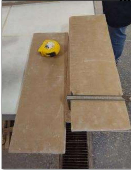
**FOTO 33.** VISTA DE LA MEDICION DE LOS ESPECIMENES PARA ENSAYO DE RESISTENCIA A LA FLEXION.
