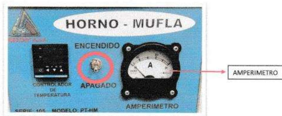
**El Amperímetro nos muestra el consumo de corriente del equipo el cual no deberá exceder los 16 A (Amperios)**
