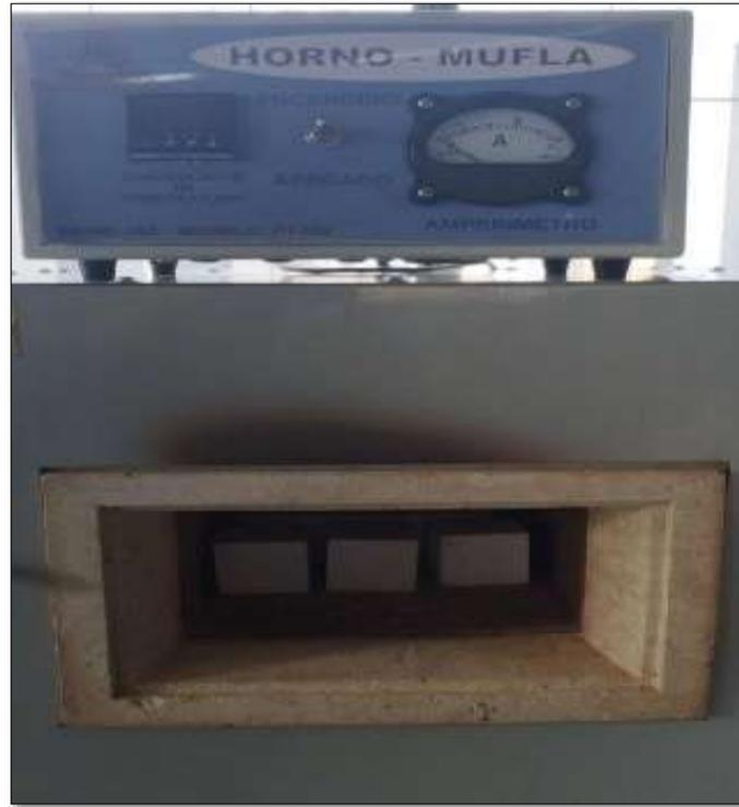
**FOTO 29.** VISTA DE COLOCADO DE MUESTRAS EN HORNO (MUFLA) EN LABORATORIO EPIC.
