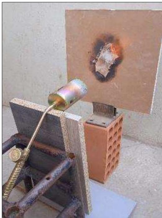
**FOTO 38.** VISTA DE INICIO AL ENSAYO DE RESITENCIA AL FUEGO EN PANELES TERMOAISLANTES.
