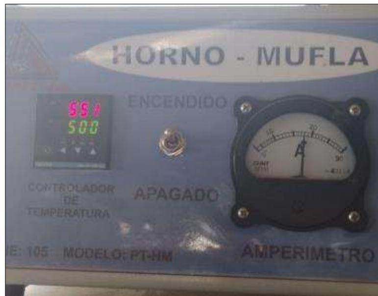
**FOTO 30.** VISTA DE CONTROLADOR DE TEMPERRATURA DE HORNO MUFLA.
