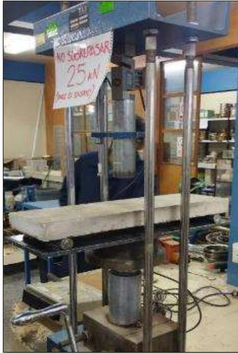
**FOTO 35.** VISTA DE LA REALIZACION DEL ENSAYO DE RESITENCIA A LA FLEXION EN LABORATORIO EPIC.
