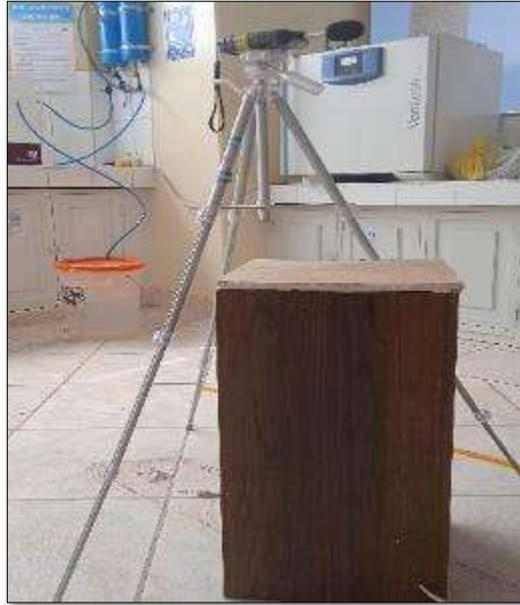
**FOTO 57.** VISTA GENERAL DE REALIZACION DEL ENSAYO (CAJA DE INSONORIZACION, PANEL TERMOAISLANTE Y SOONOMETRO)
