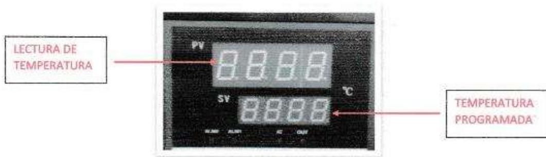
En la parte inferior del controlador están los 4 pulsadores de programación con los cuales se tiene acceso a programar (SETEAR) la temperatura de trabajo que deseamos ensayar. Este valor sólo aparece en la pantalla inferior.
