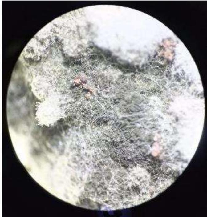
**FOTO 50.** VISTA DE LOS HONGOS EN STEROSCOPIO A 40X EN MUESTRAS DE PANEL TERMOAISLANTE.
