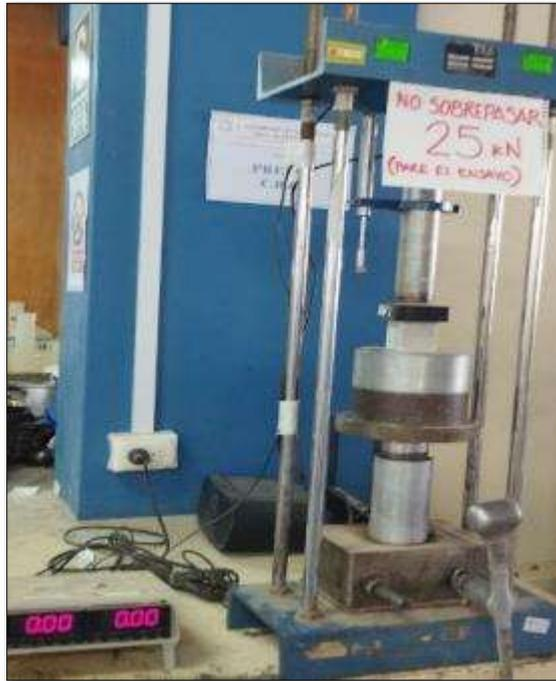
**FOTO 31.** VISTA DEL EQUIPO DE COMPRESION CBR LABORATORIO DE MECANICA DE SUELOS EPIC.
