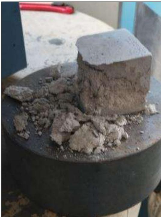
**FOTO 32.** VISTA DE MUESTRA DESPUES DE ENSAYO DE COMPRESION Y DETERMINACION DE MATERIA.
