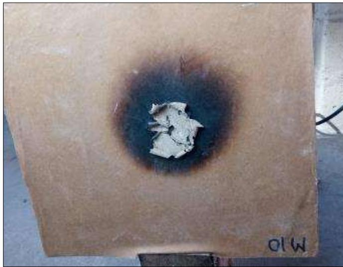
**FOTO 42.** VISTA DE EVIDENCIAS DE FISURAS EN CARA POSTERIOR DEL PANEL EXPUESTO A ENSAYO DE RESITENCIA AL FUEGO.
