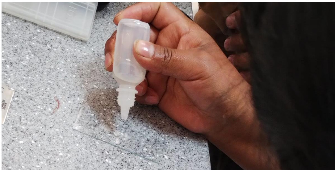
Figura 11: preparación de muestras para el análisis de medulación en el medulometro.
