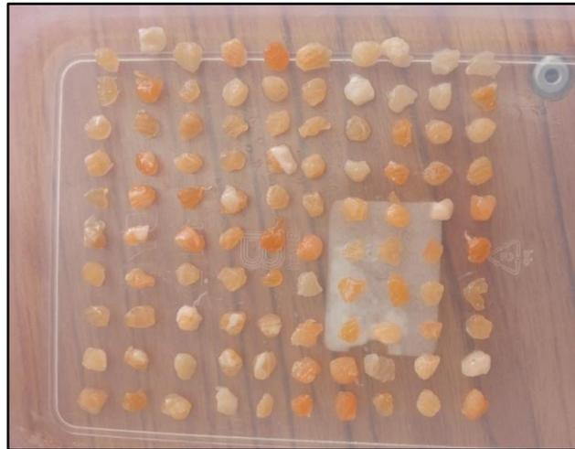
Foto 1. Trozos de muestras de 8 mm de diámetro y 2 mm de espesor.
