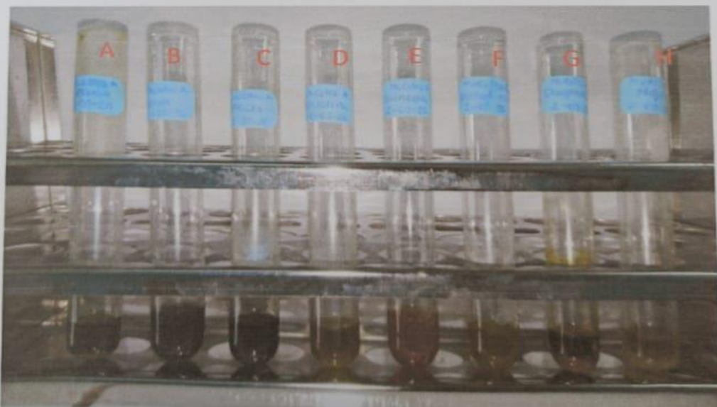
Figura 1.- Batería de tubos del tamizaje fitoquímico de MUESTRA A . A. Blanco de MUESTRA A , B. Molish, C. FeCl 3 , D. Gelatina, E. Shinoda, F. Ninhidrina, G. Dragendorff, H. Mayer
