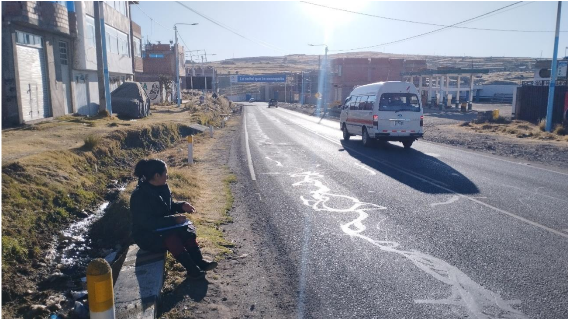
Fotografía 7. Medición de condición de tránsito (porcentaje de vehículos pesados y reparto por sentidos) mediante aforo en la vía PE-3S (Puno – Juliaca)
