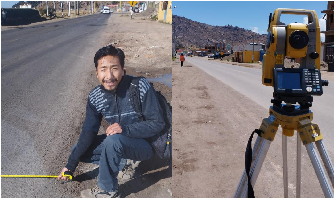
Fotografía 3. Medición de condiciones de infraestructura (ancho de carril, ancho de berma y pendiente) y control (zonas de no rebase) en la vía PE-3S (Puno – Ilave)
