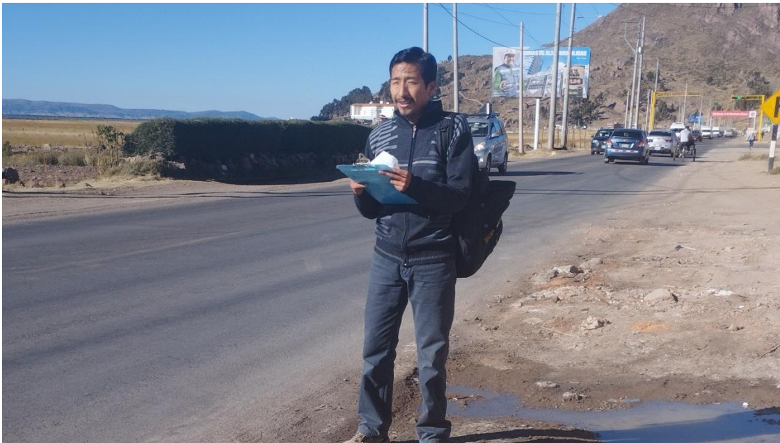
Fotografía 8. Medición de condición de tránsito (porcentaje de vehículos pesados y reparto por sentidos) mediante aforo en la vía PE-3S (Puno – Ilave)
