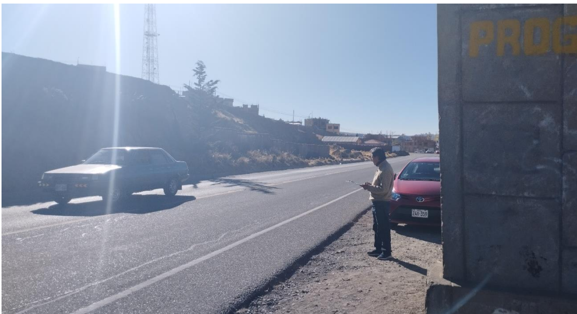
Fotografía 6. Medición de condición de tránsito (porcentaje de vehículos pesados y reparto por sentidos) mediante aforo en la vía PE-36 (Puno – Laraqueri)
