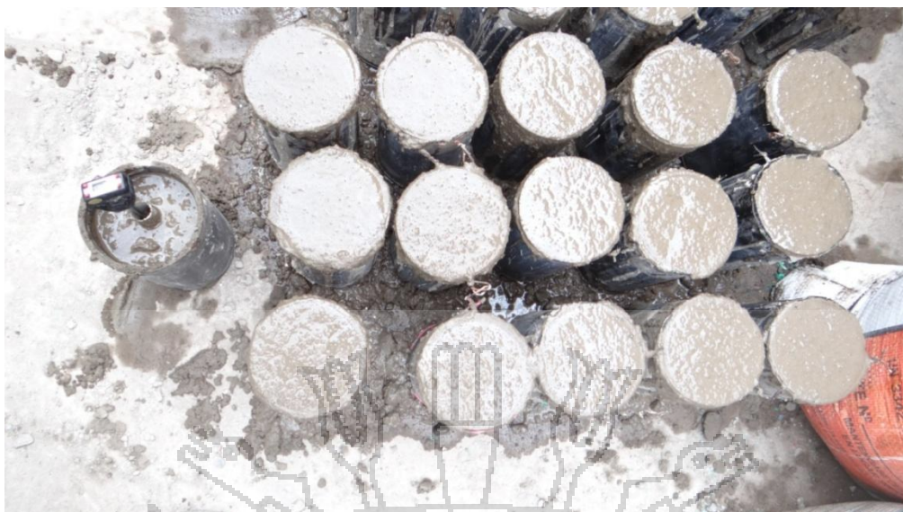
Fig. 5.42 Medición de temperatura del grupo 175 kg/cm 2 y 0% de agregado incorporado.
