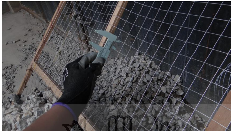
Fig. 5.14 Cribado del árido reciclado por la Malla 1"
