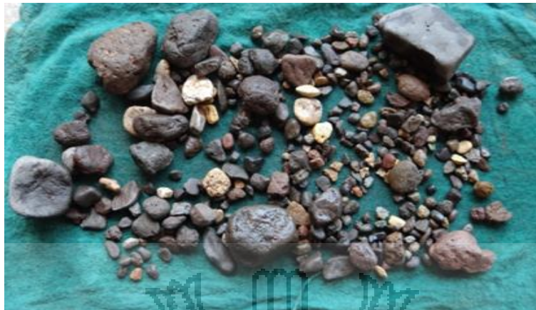
Fig. 5.22 Agregado grueso en estado S.S.S.
